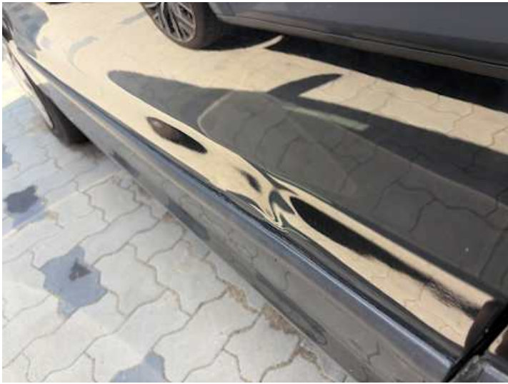
Fahrertür (Delle, Lackschaden)
