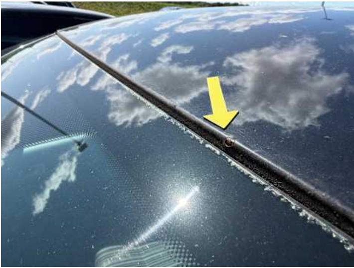
Dach (Rost, Lackschaden, Delle)
