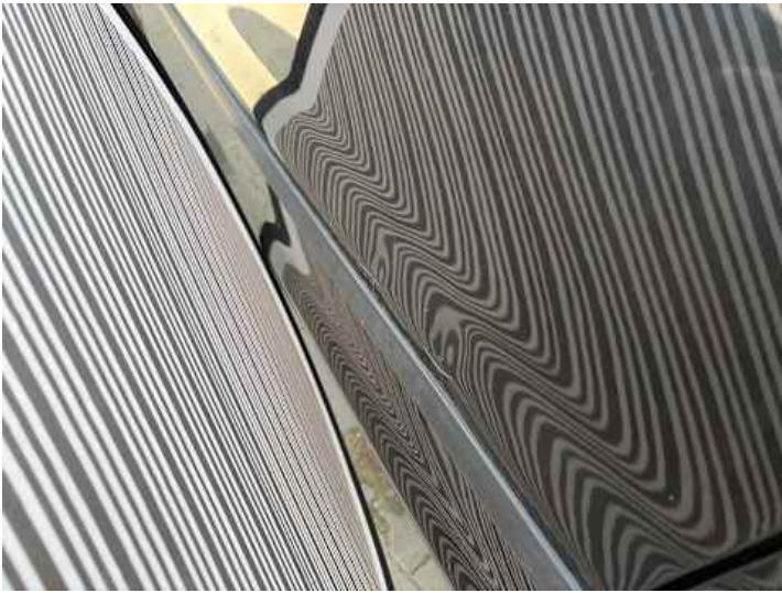
Fahrertür (Delle, Lackschaden)
