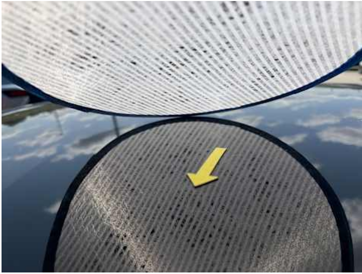
Dach (Rost, Lackschaden, Delle)
