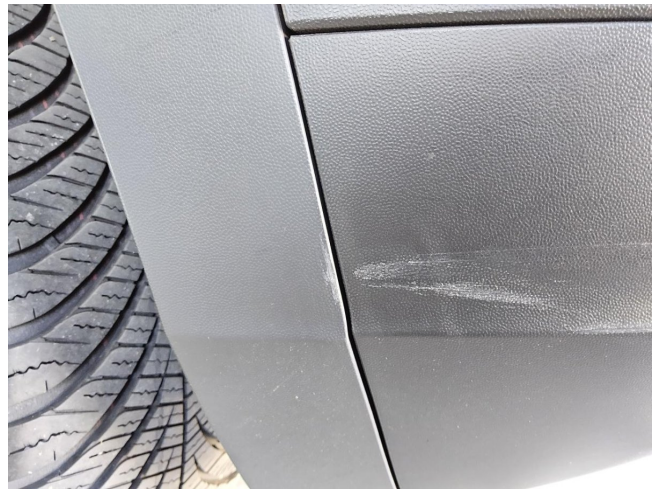
Radlaufblende hinten links Kratzer
