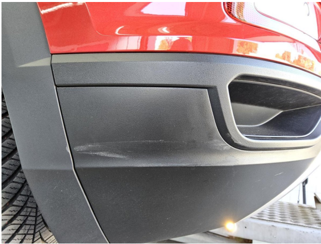
Spoilerverkleidung Stoßfänger hinten Kratzer
