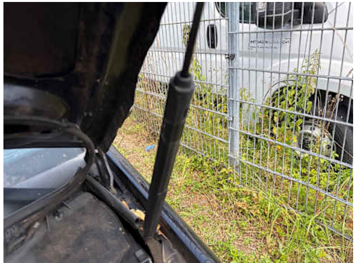
Motorhaube (Anderer Schaden): Motorhauben Dämpfer Defekt
