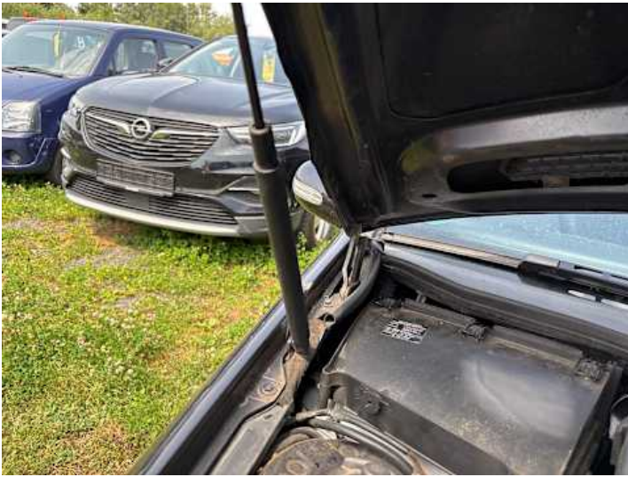
Motorhaube (Anderer Schaden): Motorhauben Dämpfer Defekt
