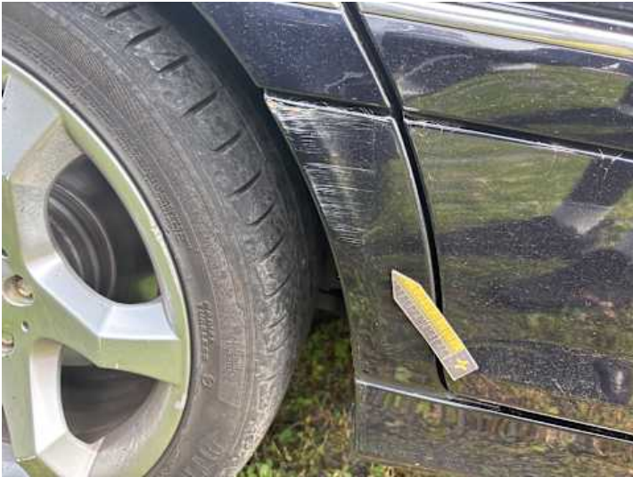
Seitenteil hinten rechts (Kratzer, Rost)
