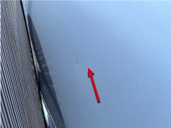
Türe hinten links (Delle)
