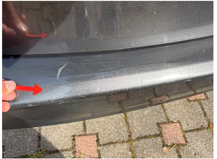
Stoßstange hinten (Kratzer, Verformung, Lackschaden, Ausgeblichen/Matt)
