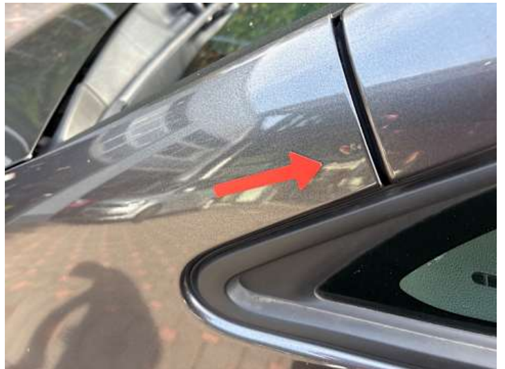
Kotflügel vorne links (Rost)
