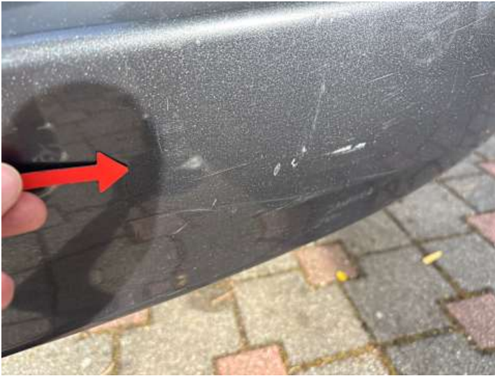
Stoßstange hinten (Kratzer, Verformung, Lackschaden, Ausgeblichen/Matt)
