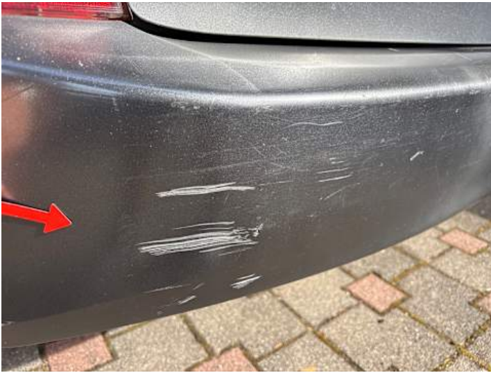
Stoßstange hinten (Kratzer, Verformung, Lackschaden, Ausgeblichen/Matt)
