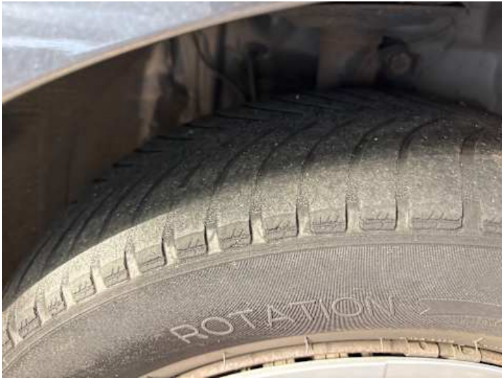
Rad (Ungleichmäßig abgefahren)
