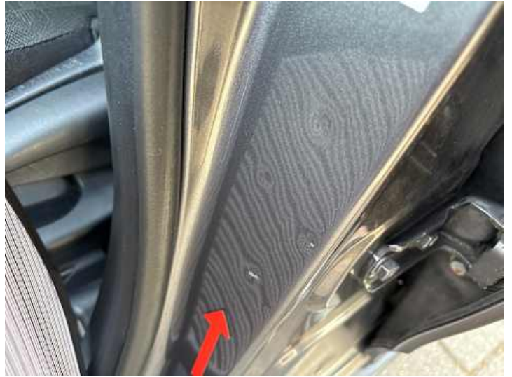
Schweller links (Kratzer, Delle)
