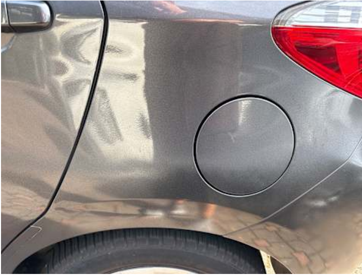
Seitenteil hinten links (Lackschaden, Ausgeblichen/Matt)
