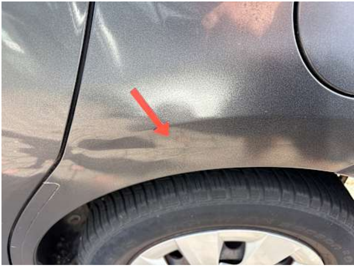
Seitenteil hinten links (Verformung)
