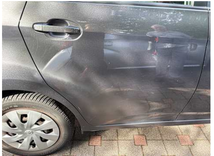
Türe hinten rechts (Ausgeblichen/Matt, Lackschaden)
