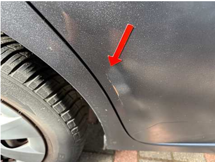
Türe hinten rechts (Kratzer, Rost)
