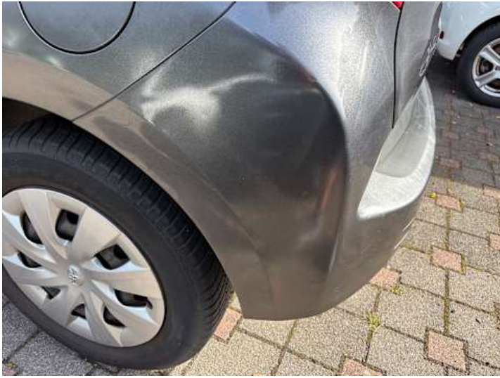
Stoßstange hinten (Kratzer, Verformung, Lackschaden, Ausgeblichen/Matt)
