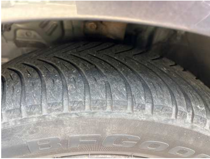
Rad (Ungleichmäßig abgefahren)
