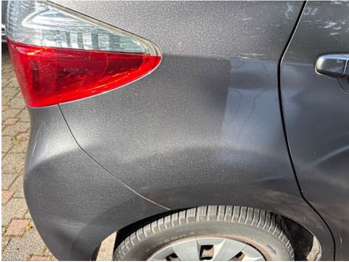
Seitenteil hinten rechts (Ausgeblichen/Matt, Lackschaden)
