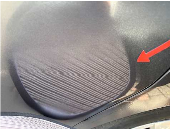
Türe hinten links (Verformung)
