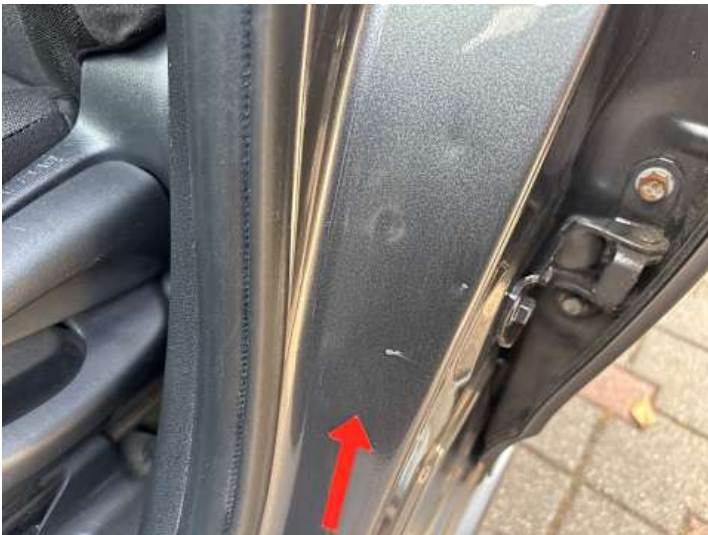
Schweller links (Kratzer, Delle)
