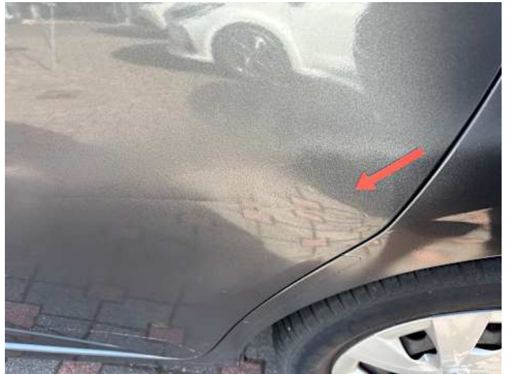
Türe hinten links (Verformung)
