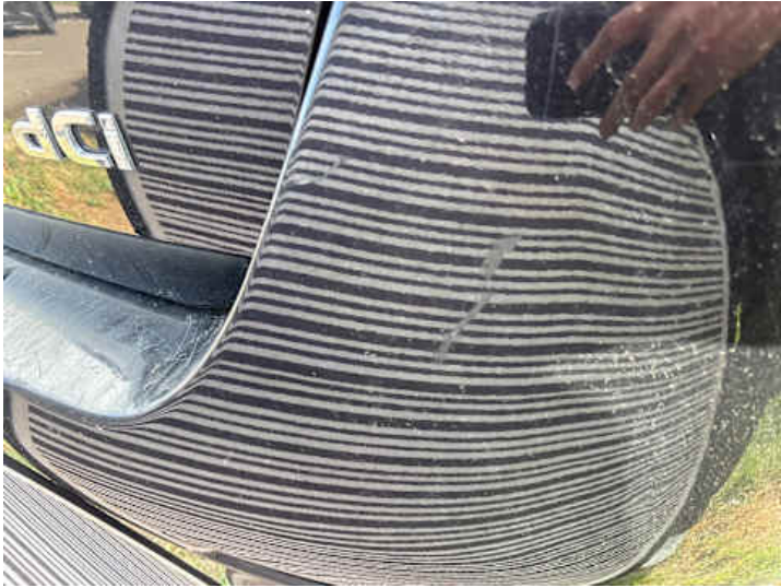
Stoßstange hinten (Delle, Kratzer)
