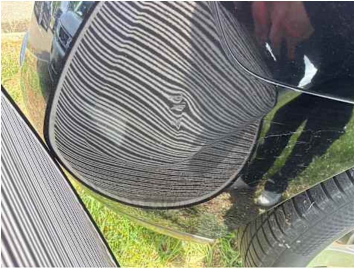
Stoßstange hinten (Delle, Kratzer)
