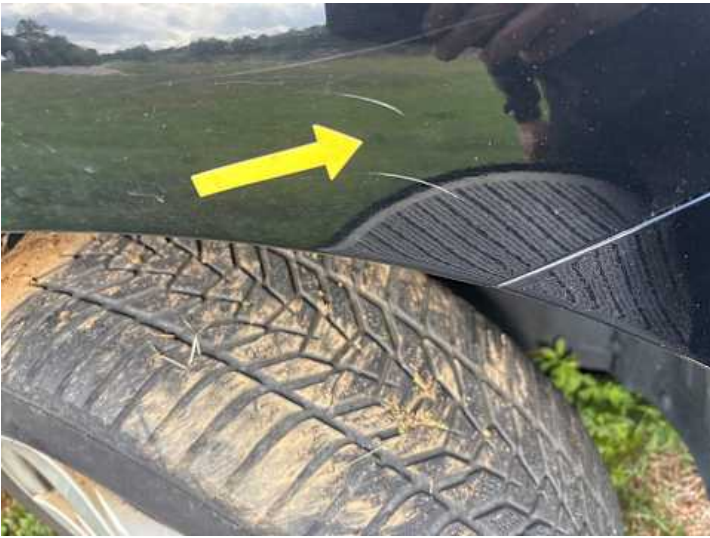
Kotflügel vorne rechts (Kratzer)
