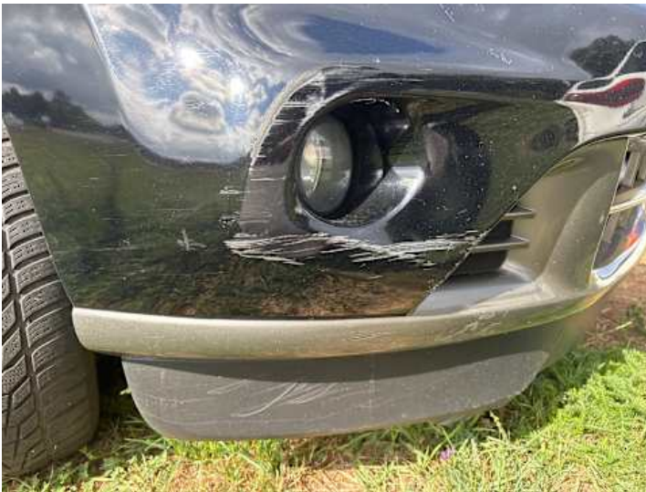
Stoßstange vorne (Kratzer, Unsachgemäß instand gesetzt)
