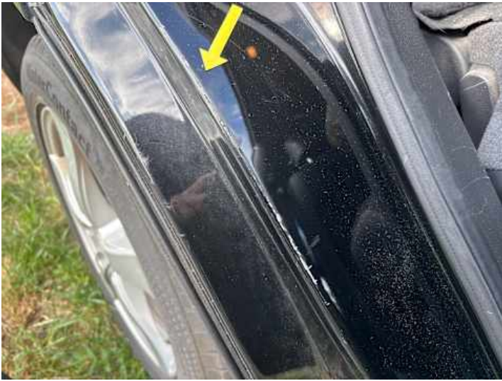
Türe hinten rechts (Kratzer)
