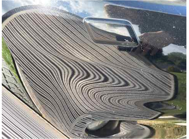
Stoßstange vorne (Kratzer, Unsachgemäß instand gesetzt)
