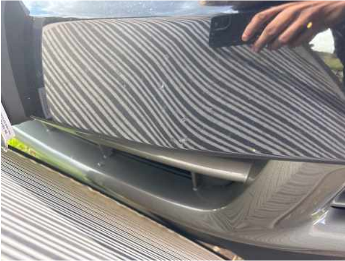
Stoßstange vorne (Kratzer, Unsachgemäß instand gesetzt)
