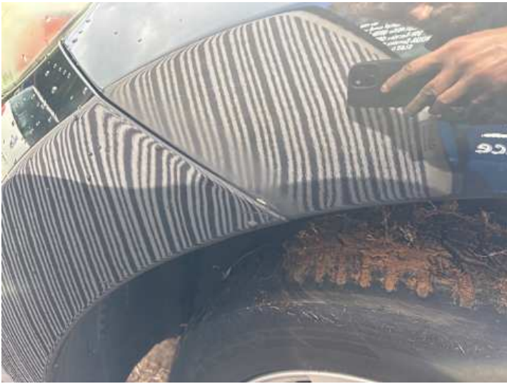
Kotflügel vorne links (Ausgeblichen/Matt, Lackschaden, Kratzer, Unsachgemäß instand gesetzt)
