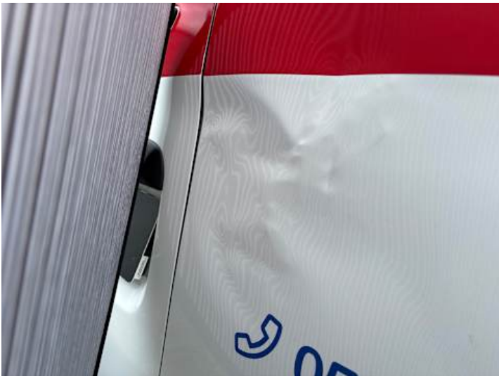
Heckklappe (Verformung, Lackschaden, Delle)
