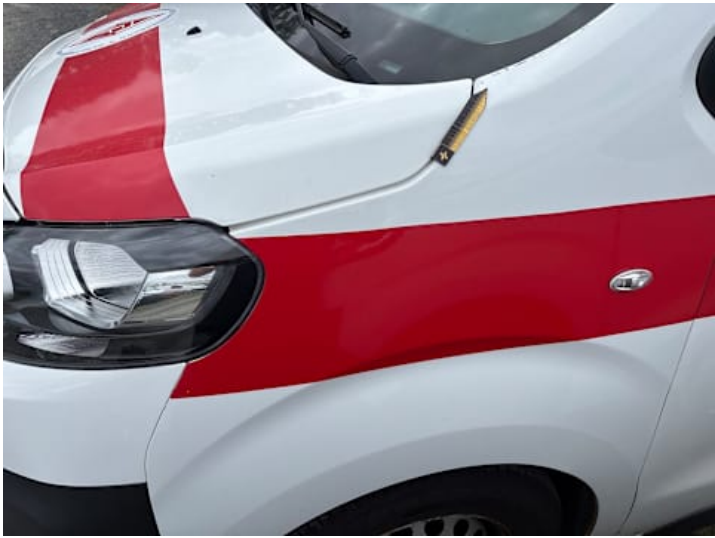
Kotflügel vorne links (Kratzer, Rost)
