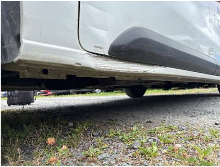
Schweller rechts (Verformung, Kratzer, Lackschaden)
