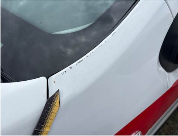
Kotflügel vorne links (Kratzer, Rost)
