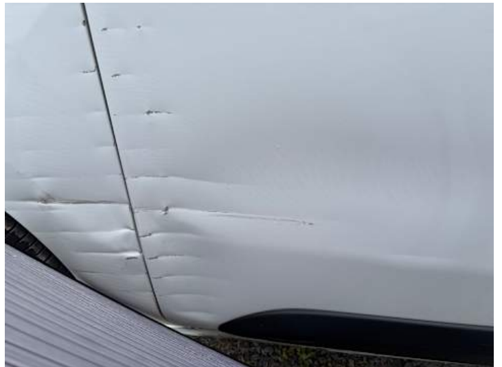
Türe hinten rechts (Kratzer, Delle, Verformung, Lackschaden)
