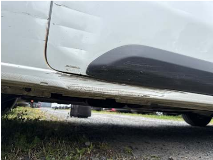
Schweller rechts (Verformung, Kratzer, Lackschaden)
