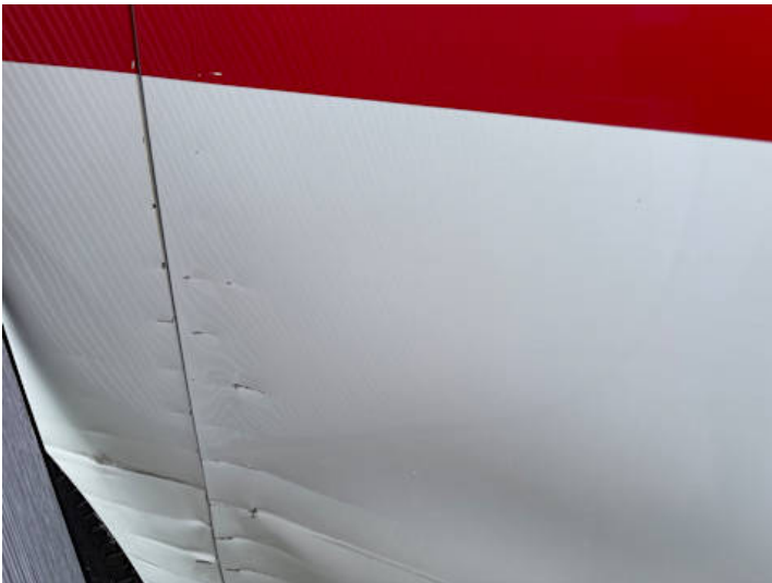
Türe hinten rechts (Kratzer, Delle, Verformung, Lackschaden)
