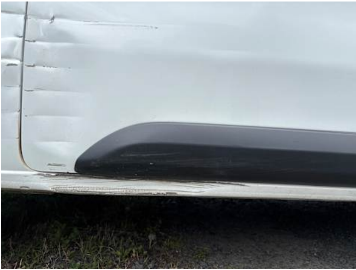
Türe hinten rechts (Kratzer, Delle, Verformung, Lackschaden)
