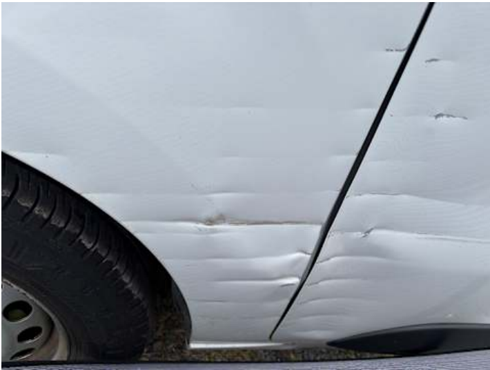
Seitenteil hinten rechts (Verformung, Lackschaden, Kratzer, Delle)
