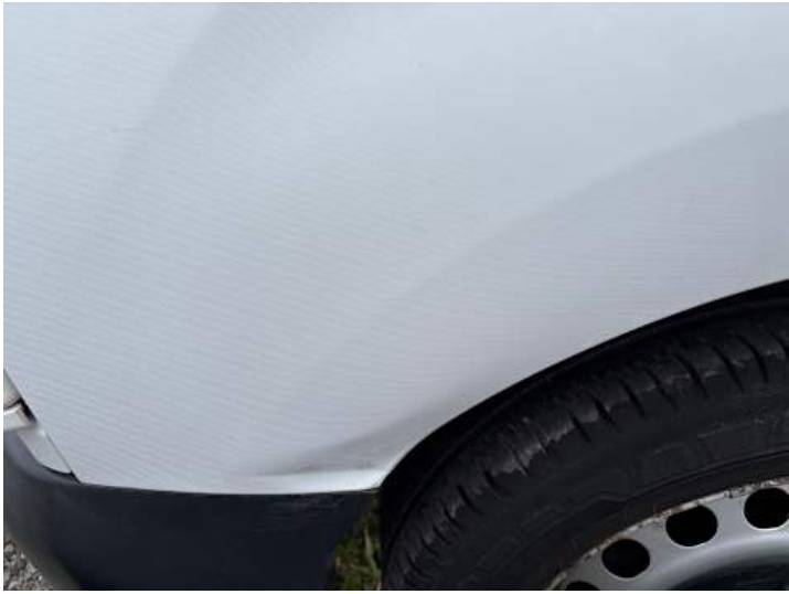
Seitenteil hinten rechts (Verformung, Lackschaden, Kratzer, Delle)
