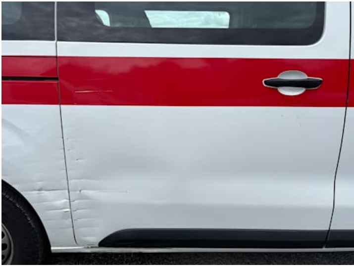
Türe hinten rechts (Kratzer, Delle, Verformung, Lackschaden)
