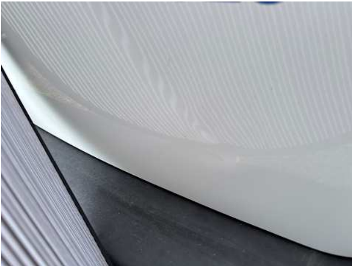
Heckklappe (Verformung, Lackschaden, Delle)
