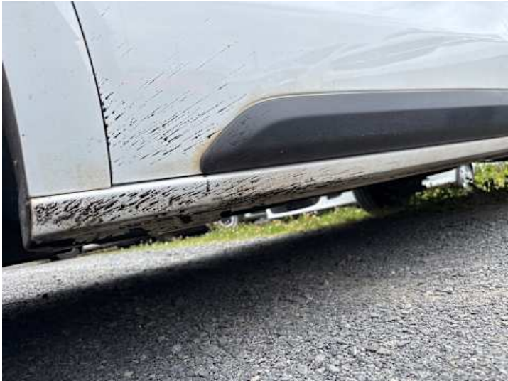
Schweller links (Anderer Schaden): Verschmutzung
