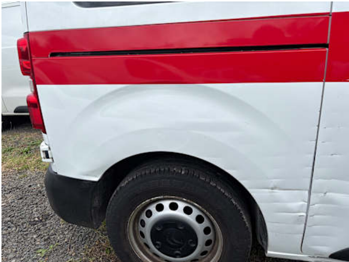
Seitenteil hinten rechts (Verformung, Lackschaden, Kratzer, Delle)
