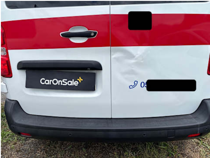
Heckklappe (Verformung, Lackschaden, Delle)
