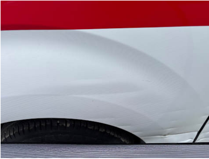
Seitenteil hinten rechts (Verformung, Lackschaden, Kratzer, Delle)
