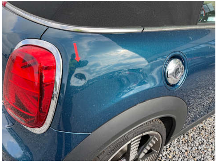
Seitenteil hinten rechts (Verformung)
