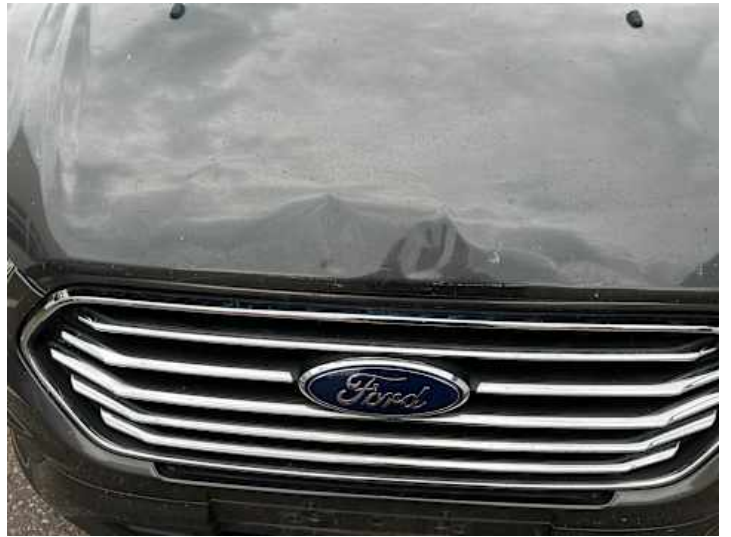
Motorhaube (Anderer Schaden): Motorhaube schließt nicht mehr
