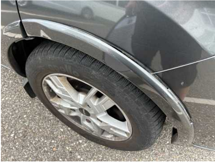
Kotflügel vorne rechts (Anderer Schaden): Abdeckung lose
