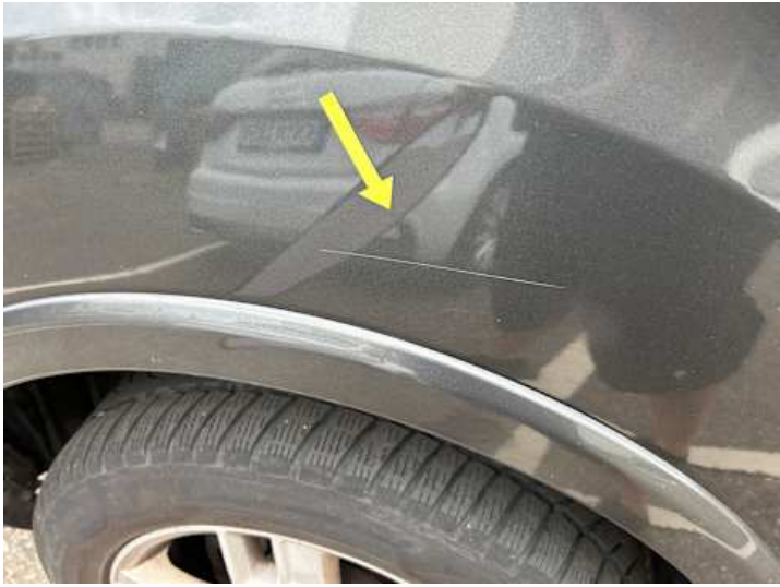
Seitenteil hinten rechts (Kratzer)
