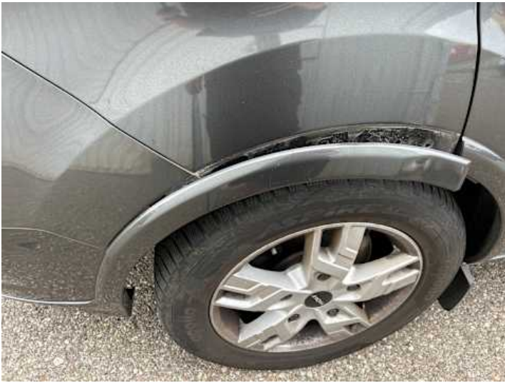
Kotflügel vorne links (Anderer Schaden): Abdeckung lose
