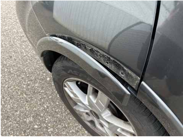
Kotflügel vorne links (Anderer Schaden): Abdeckung lose
