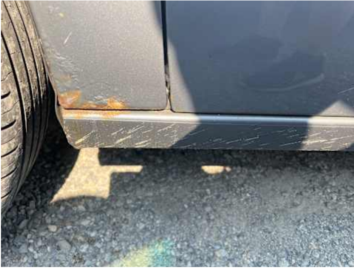
Schweller links (Rost)
