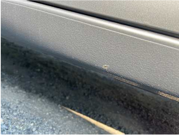
Schweller links (Rost)
