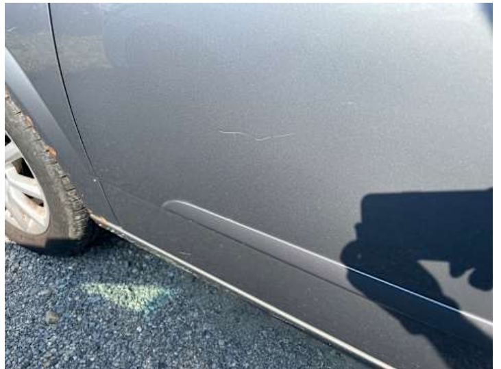
Fahrtür (Rost, Lackschaden)
