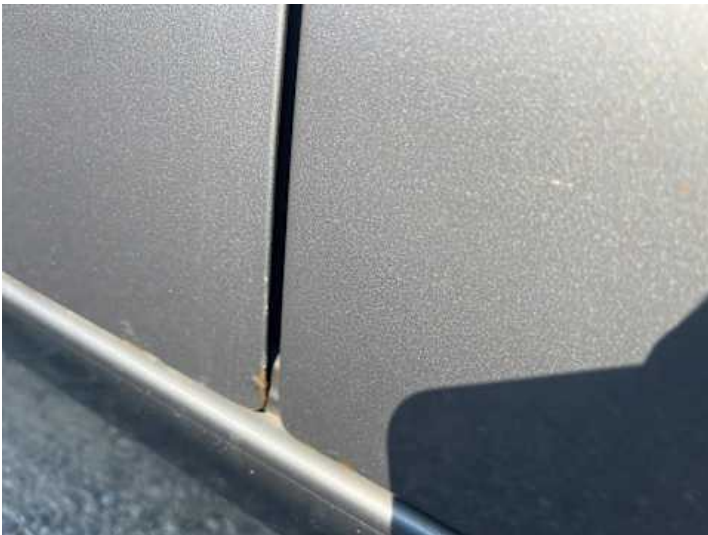
Fahrtür (Rost, Lackschaden)
