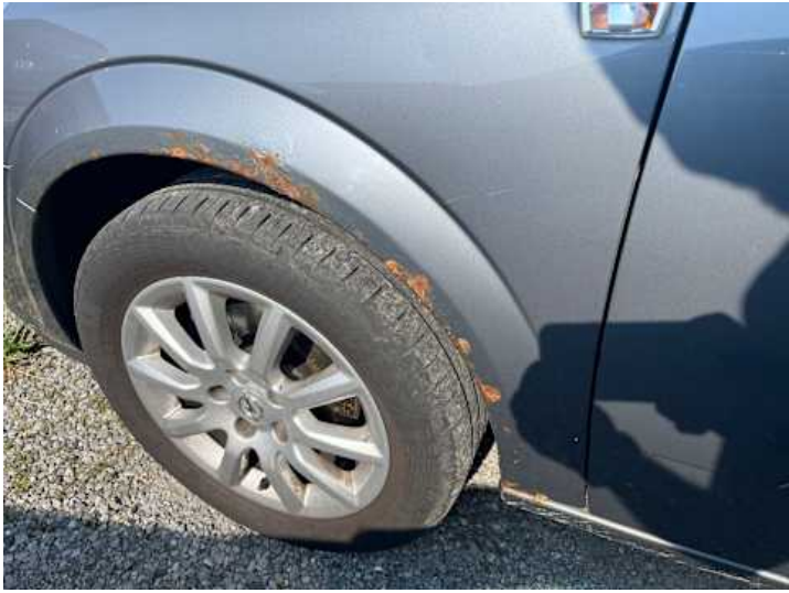
Kotflügel vorne links (Rost, Lackschaden)
