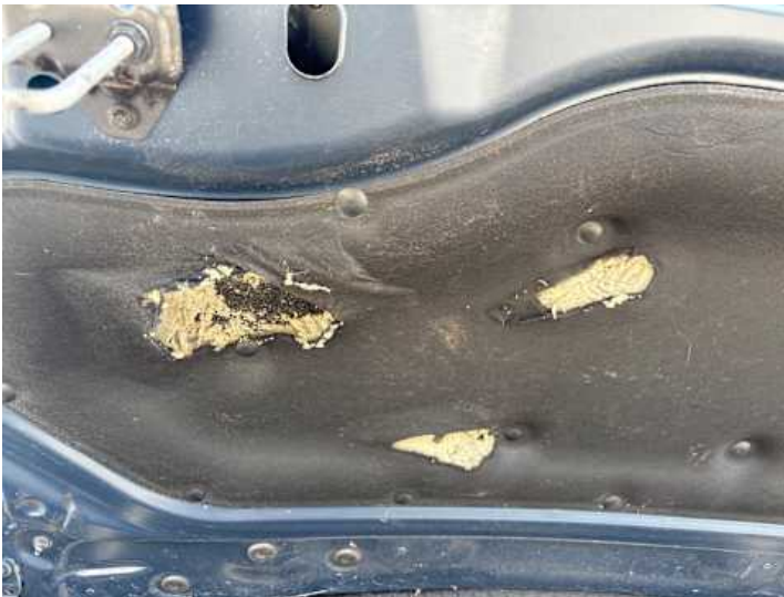
Motorhaube (Anderer Schaden): Dämmung beschädigt
