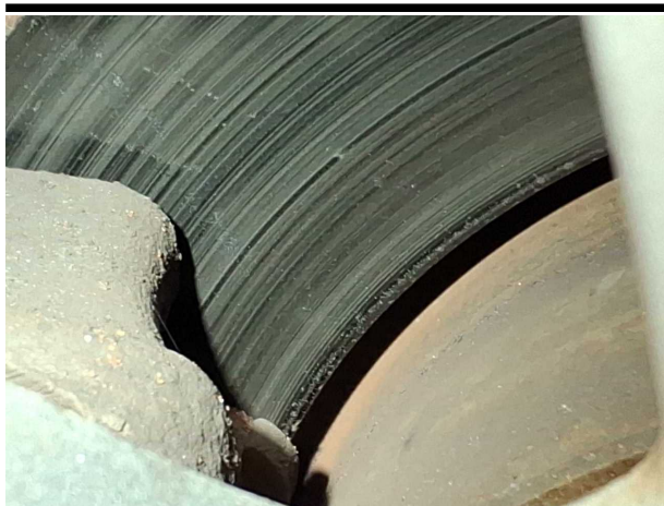
Beschädigung #3: Bremsanlage: Bremsscheiben und Beläge hinten (Verglüht) - verschlissen - erneuern
