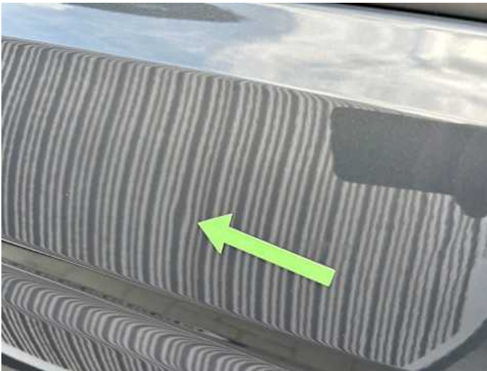
Beifahrertür (Kratzer, Delle)
