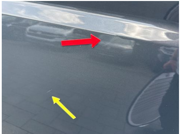
Beifahrertür (Kratzer, Delle)
