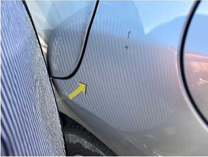
Seitenteil hinten links (Kratzer, Delle)
