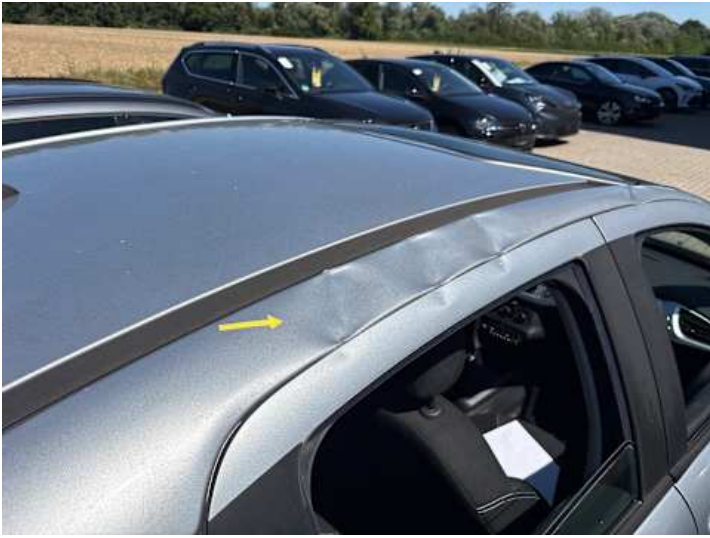
Dach (Verformung, Delle, Riss/Bruch, Lackschaden)
