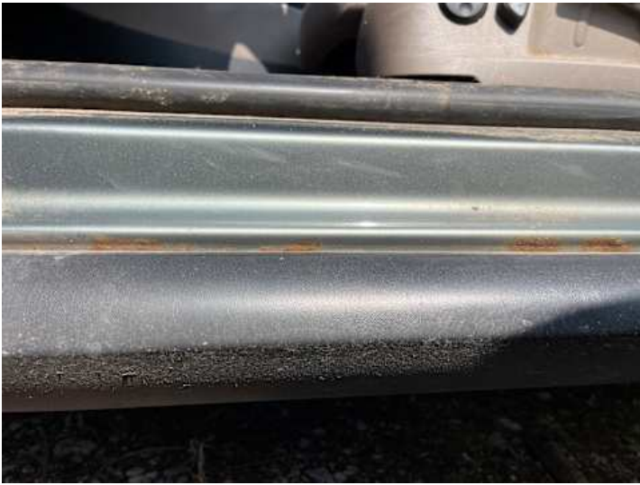
Schweller links (Rost, Lackschaden)
