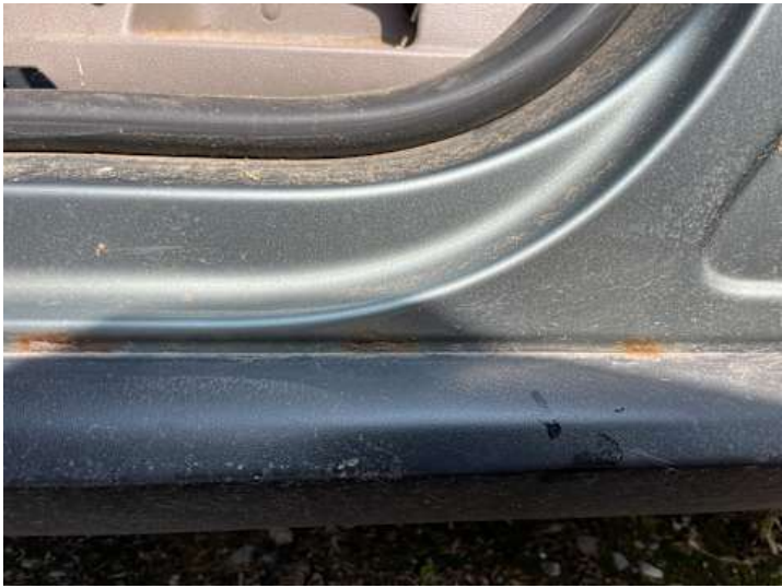
Schweller links (Rost, Lackschaden)
