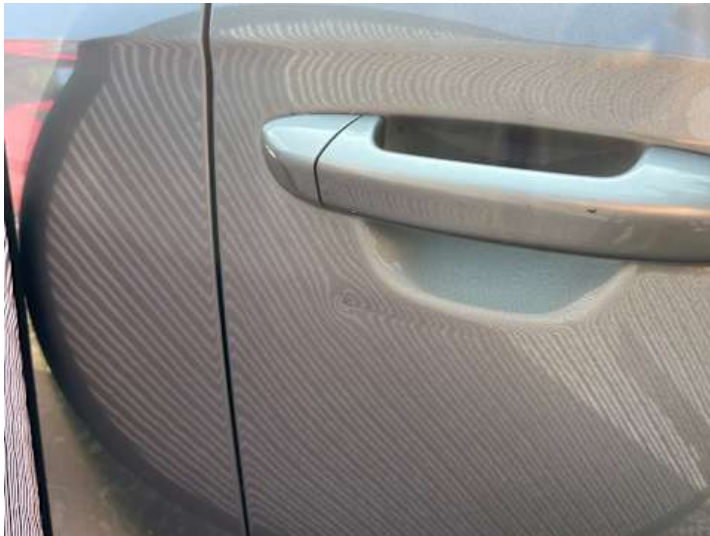
Beifahrertür (Lackschaden, Rost, Delle)
