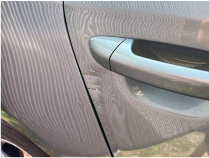
Türe hinten rechts (Verformung, Lackschaden, Rost)
