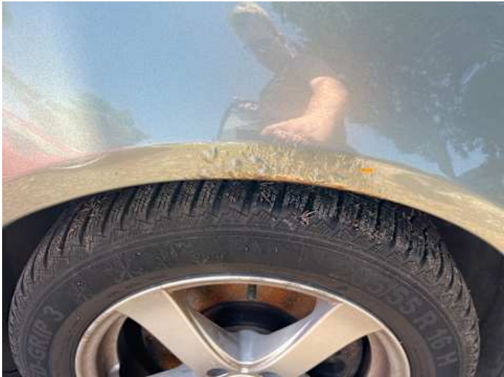
Kotflügel vorne rechts (Rost, Lackschaden)
