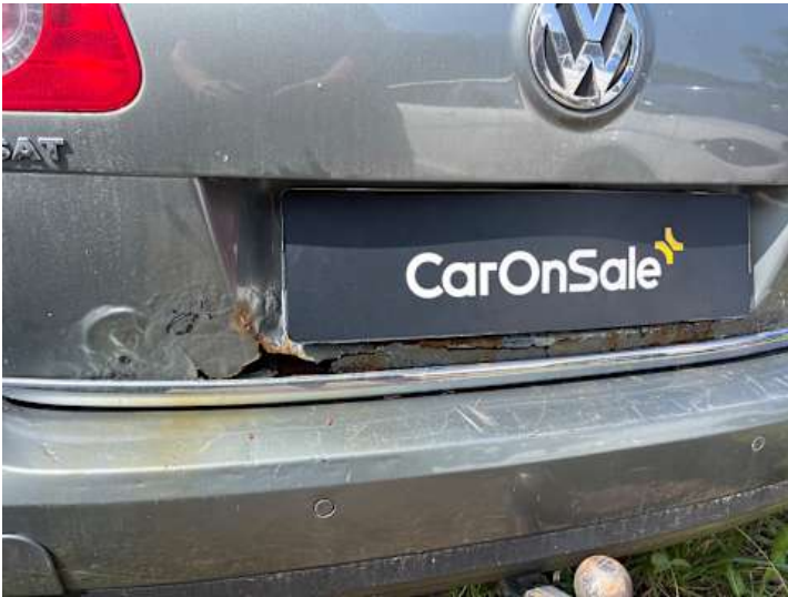
Heckklappe (Rost, Lackschaden)
