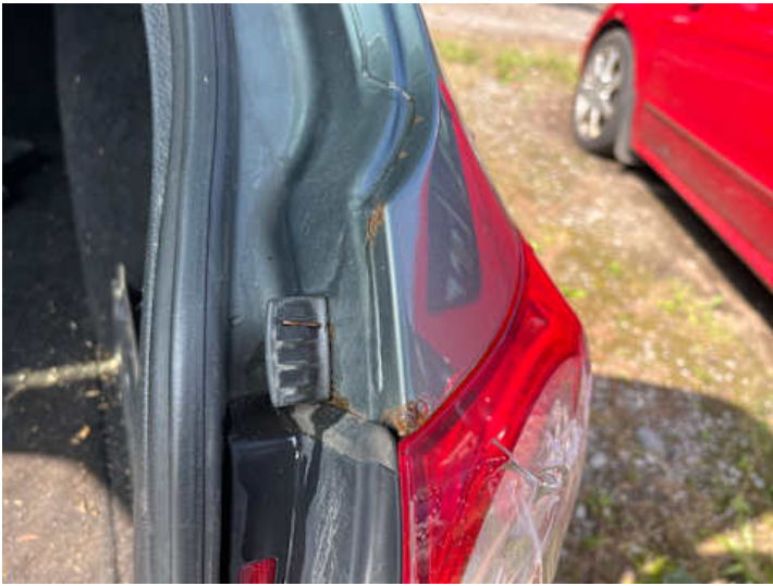
Seitenteil hinten rechts (Lackschaden, Rost)
