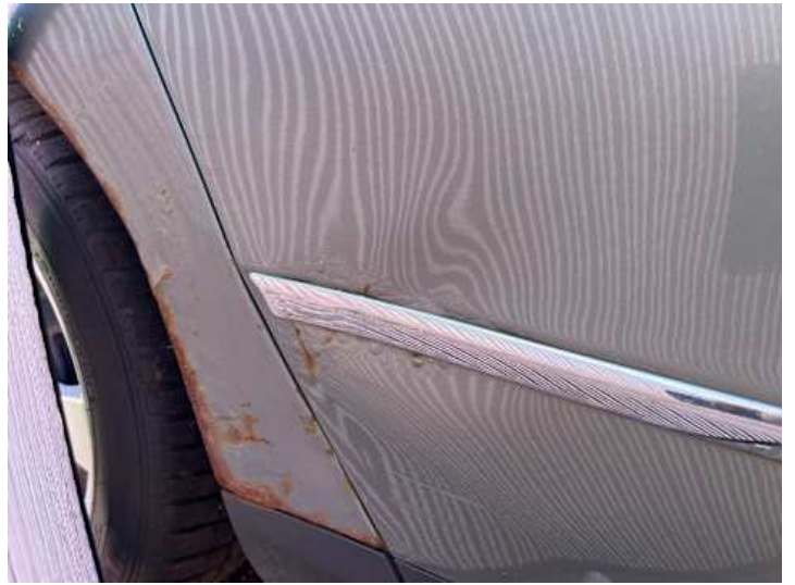
Türe hinten rechts (Verformung, Lackschaden, Rost)
