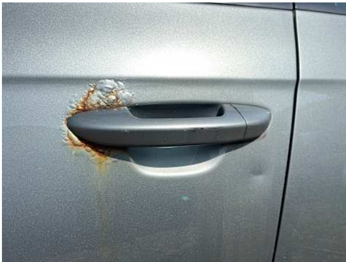
Fahrertür (Rost, Lackschaden, Delle)
