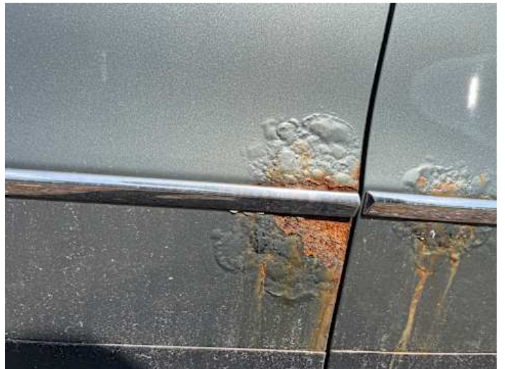
Fahrtür (Rost, Lackschaden, Delle)
