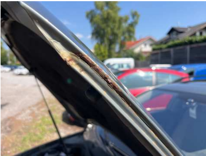
Motorhaube (Rost, Lackschaden)
