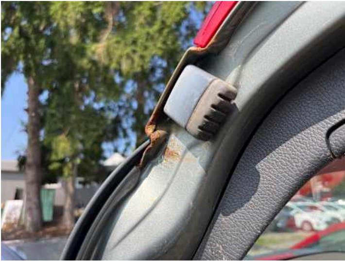
Heckklappe (Rost, Lackschaden)
