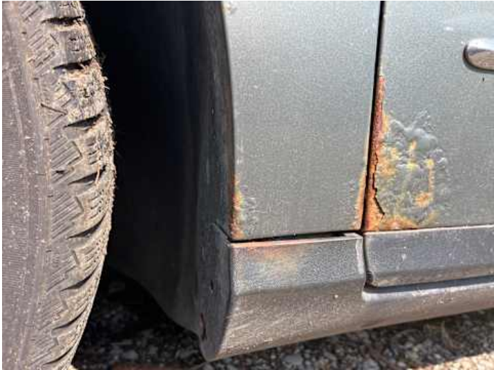
Kotflügel vorne links (Rost, Lackschaden)
