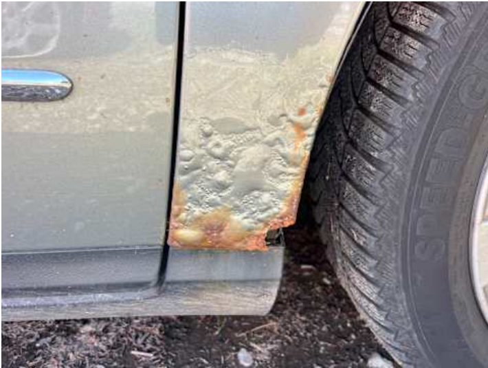
Kotflügel vorne rechts (Rost, Lackschaden)
