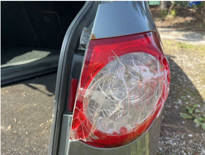
Rücklicht (rechts) (Riss/Bruch)
