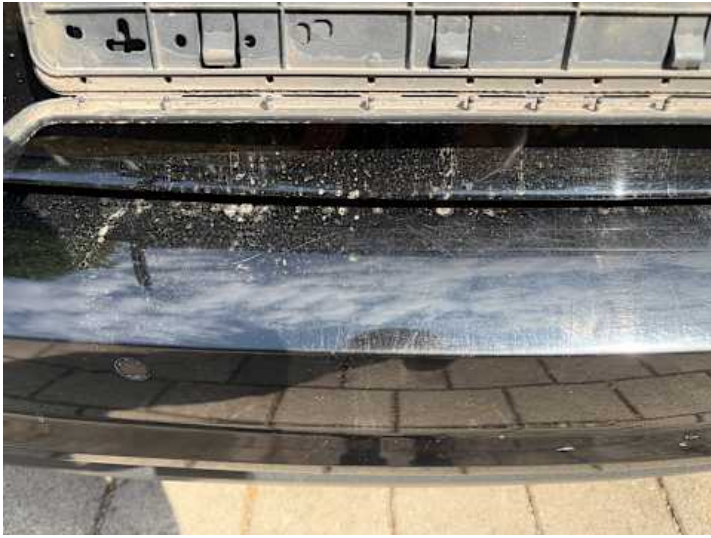
Stoßstange hinten (Kratzer)
