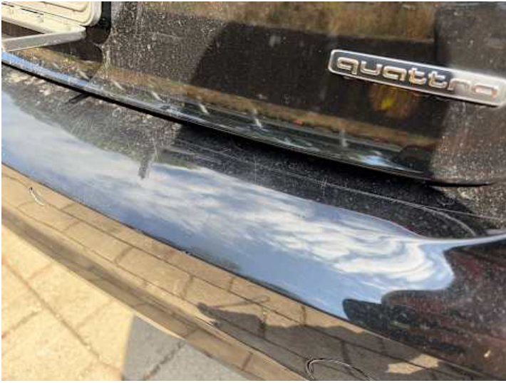
Stoßstange hinten (Kratzer)
