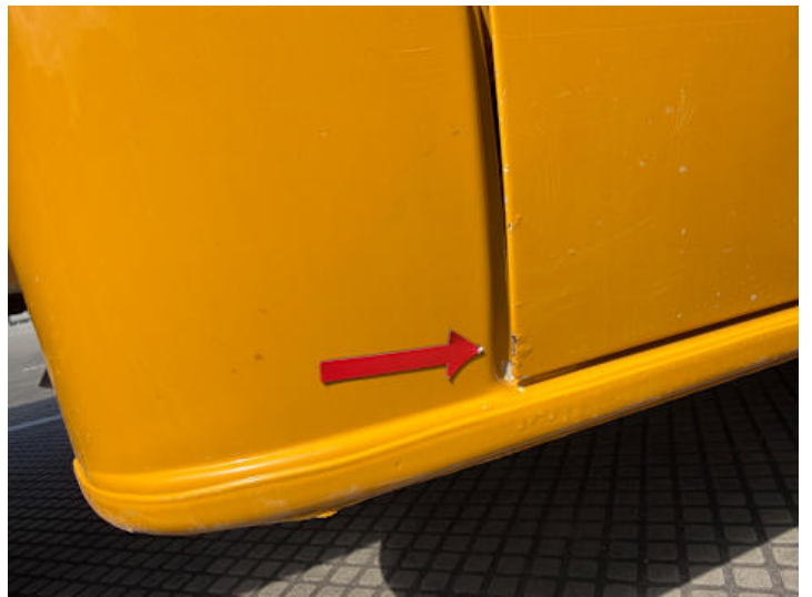
Türe hinten rechts (Rost)
