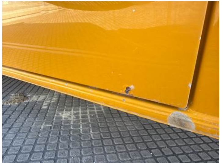
Türe hinten links (Rost)
