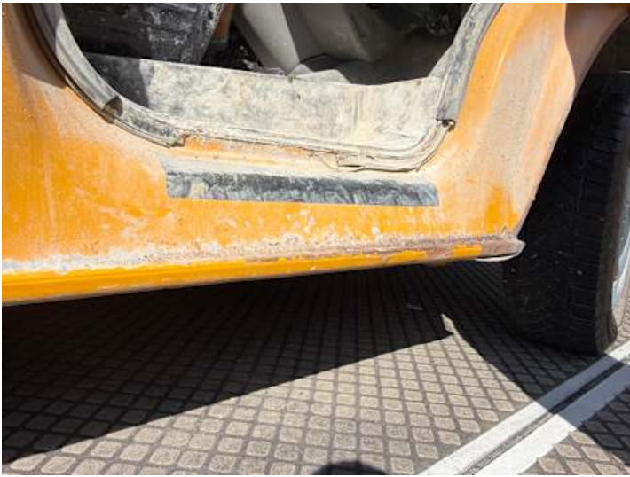
Schweller rechts (Lackschaden, Rost)
