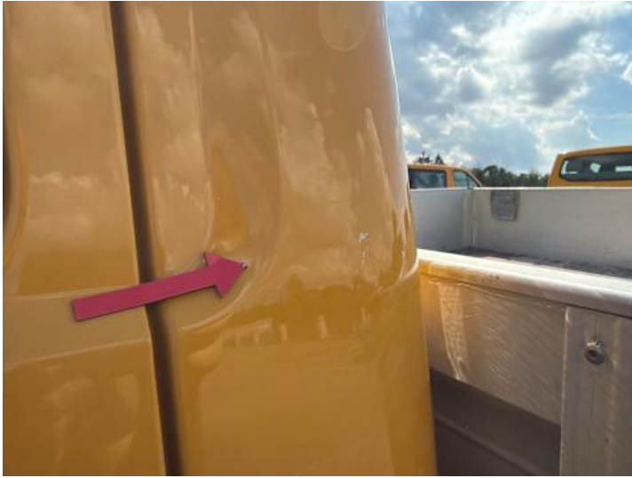
Seitenteil hinten links (Lackschaden)
