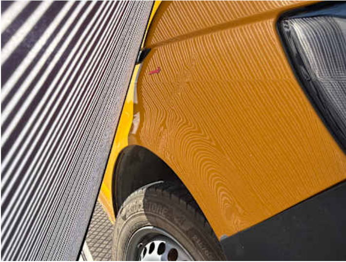
Kotflügel vorne rechts (Verformung, Lackschaden)
