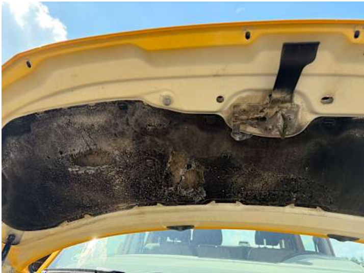
Motorhaube (Anderer Schaden): Motordämmung defekt
