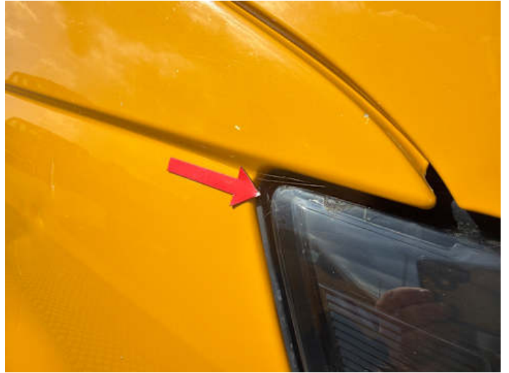
Scheinwerfer (rechts) (Riss/Bruch)
