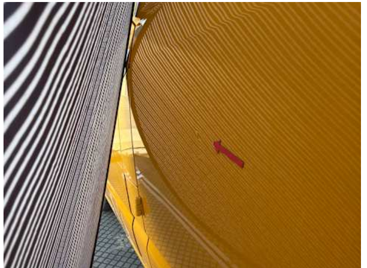
Türe hinten links (Verformung, Delle)
