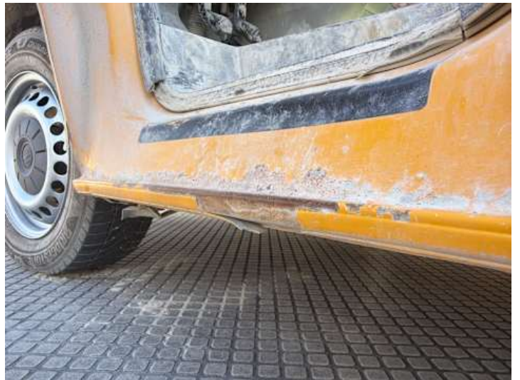
Schweller links (Rost, Lackschaden)
