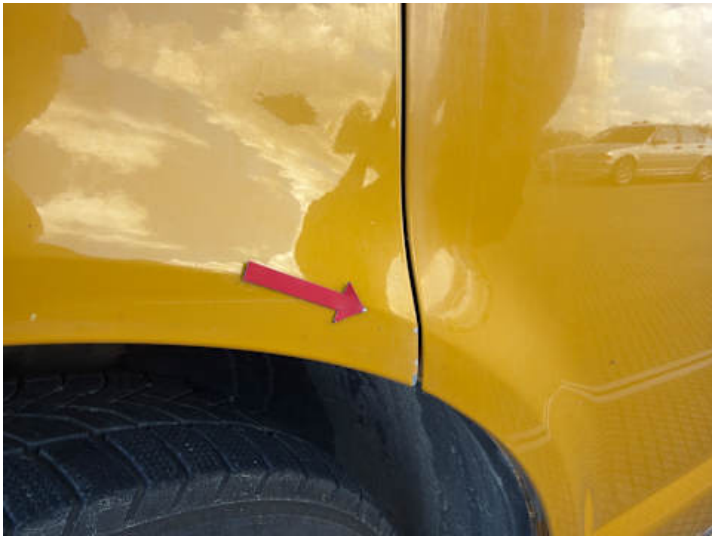
Kotflügel vorne links (Lackschaden)
