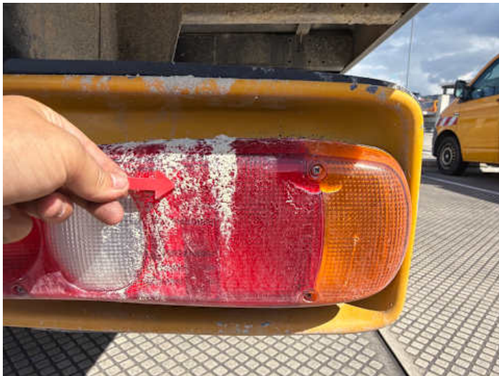
Rücklicht (rechts) (Riss/Bruch)
