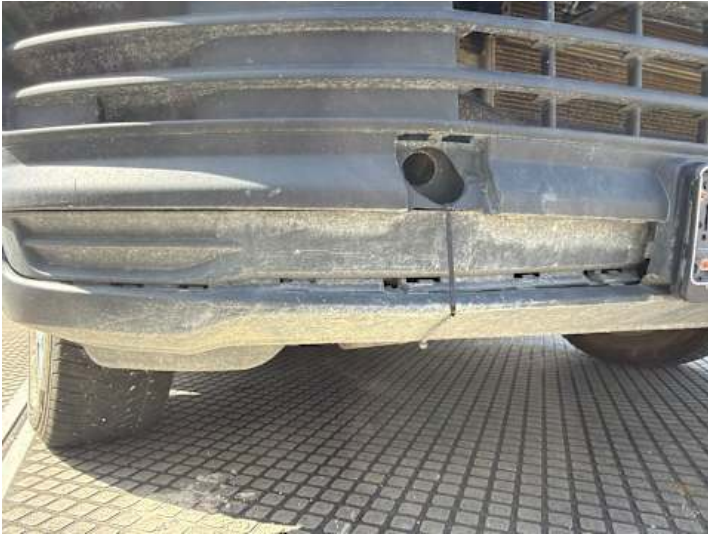
Stoßstange vorne (Riss/Bruch, Unsachgemäß instand gesetzt)
