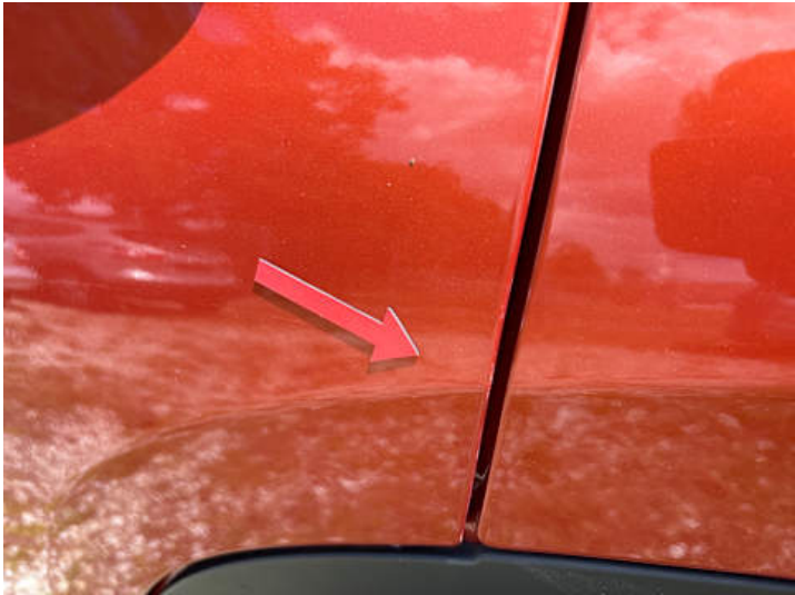
Türe hinten links (Lackschaden)
