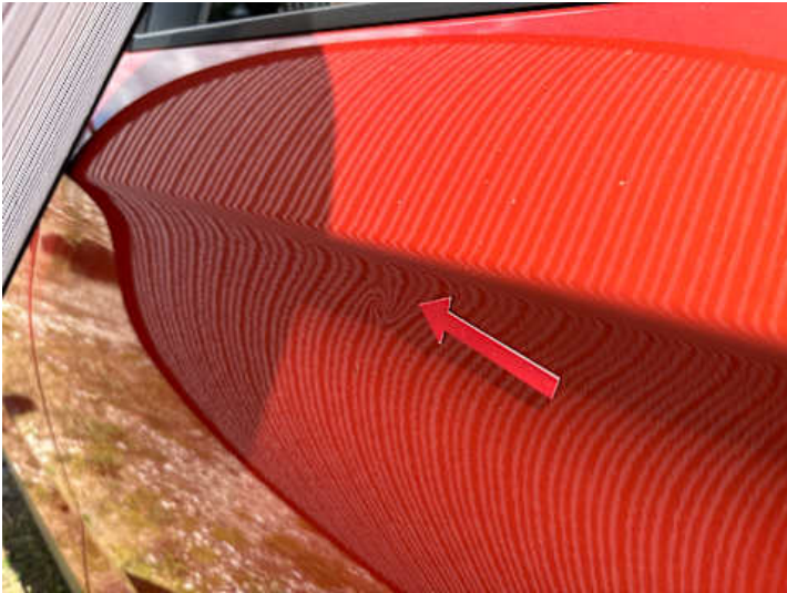
Türe hinten links (Delle)
