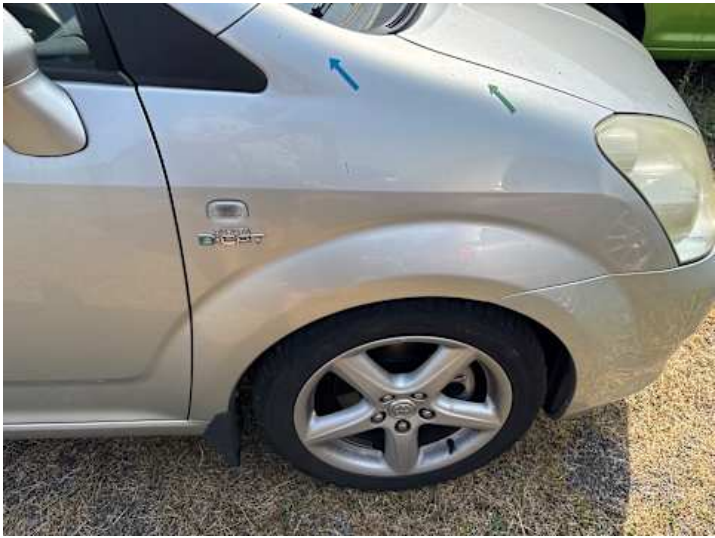
Kotflügel vorne rechts (Delle, Kratzer)
