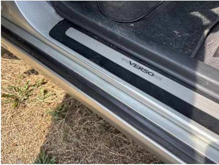
Schweller links (Lackschaden)
