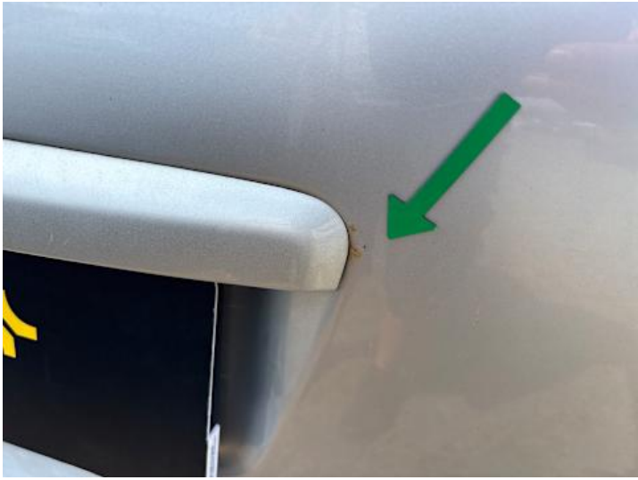
Heckklappe (Kratzer, Rost)
