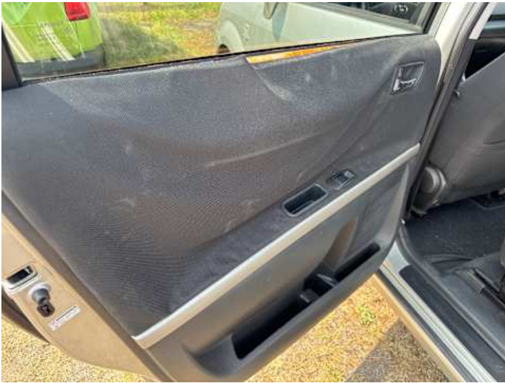
Innenraum (Riss/Bruch, Verschleiß)
