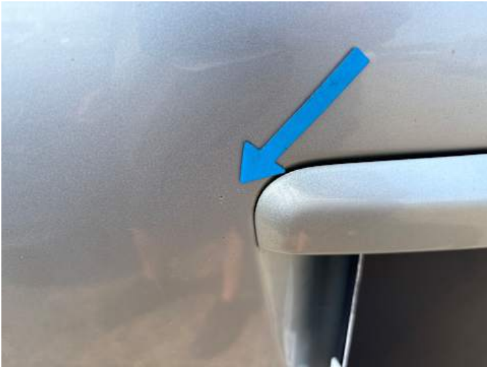
Heckklappe (Kratzer, Rost)
