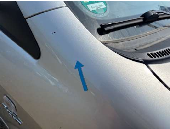
Kotflügel vorne rechts (Delle, Kratzer)
