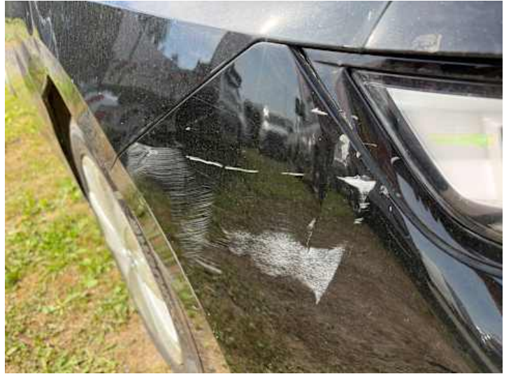
Stoßstange vorne (Riss/Bruch, Lackschaden, Spaltmaße ungenau, Anderer Schaden): Unfallschaden
