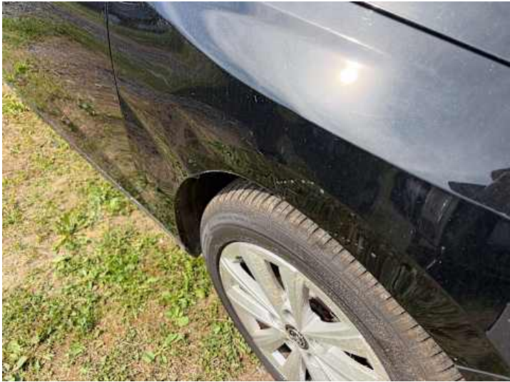
Kotflügel vorne rechts (Anderer Schaden, Delle, Lackschaden): Unfallsschaden
