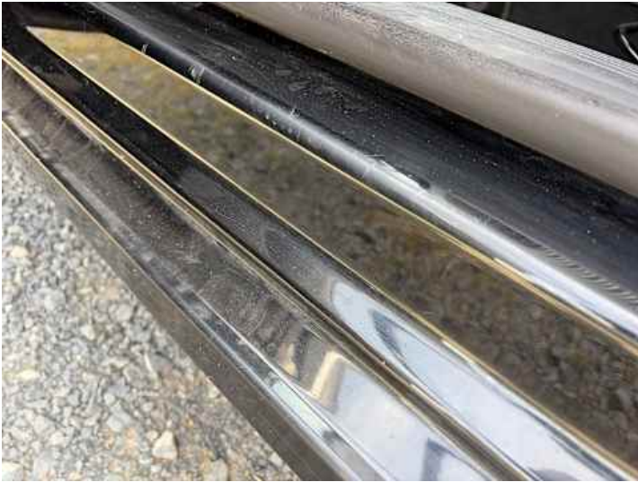
Schweller links (Kratzer)
