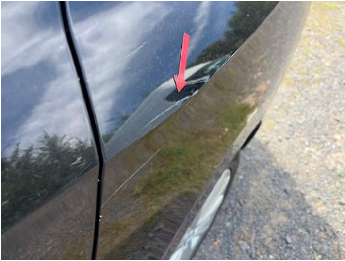
Türe hinten links (Lackschaden)
