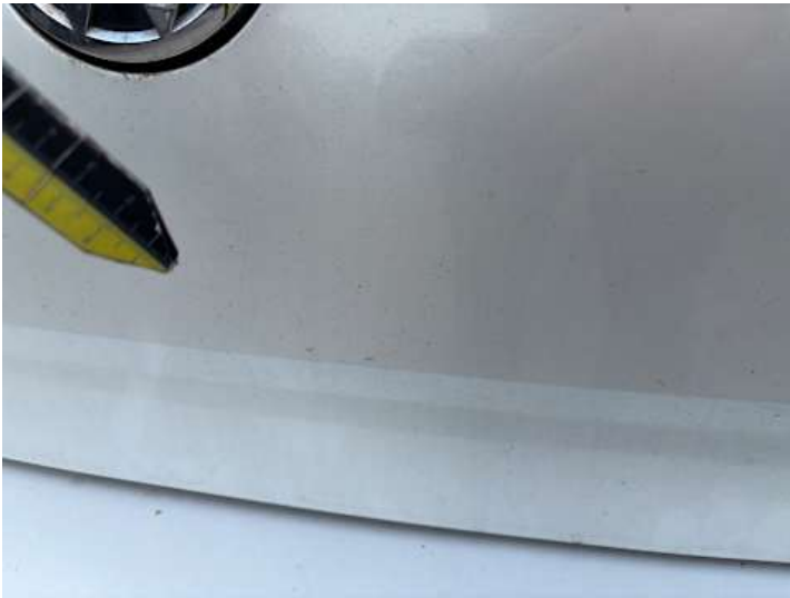
Heckklappe (Lackschaden, Kratzer)
