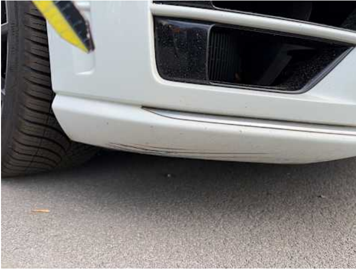
Stoßstange vorne (Lackschaden, Kratzer)
