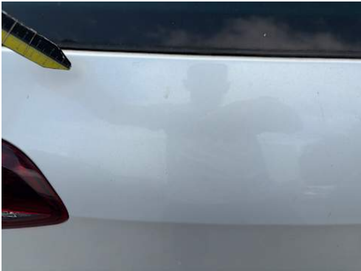
Heckklappe (Lackschaden, Kratzer)
