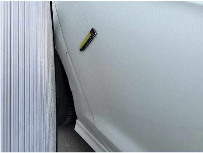
Türe hinten rechts (Delle, Verformung)
