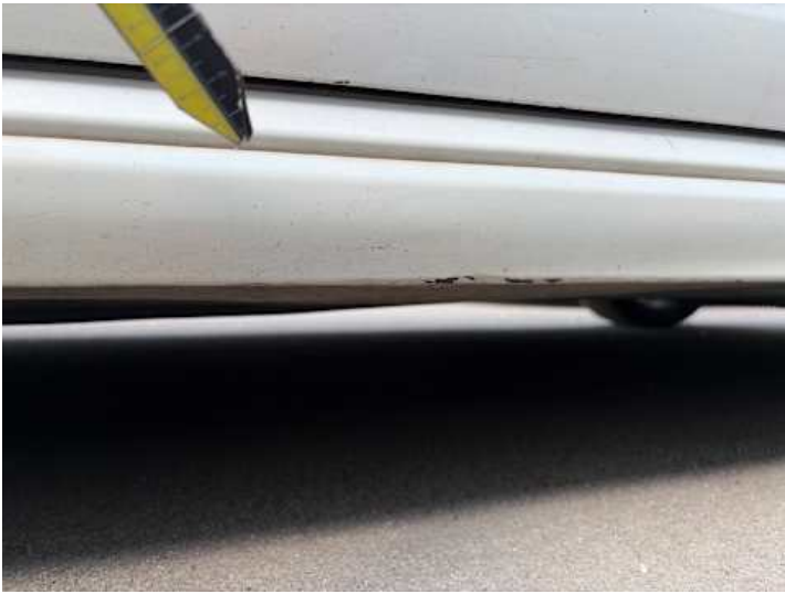
Schweller links (Lackschaden, Kratzer, Verformung)
