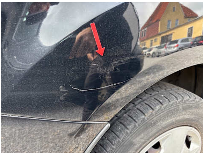
Seitenteil hinten rechts (Kratzer)
