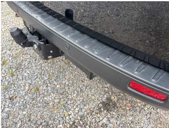
Stoßstange hinten (Kratzer)
