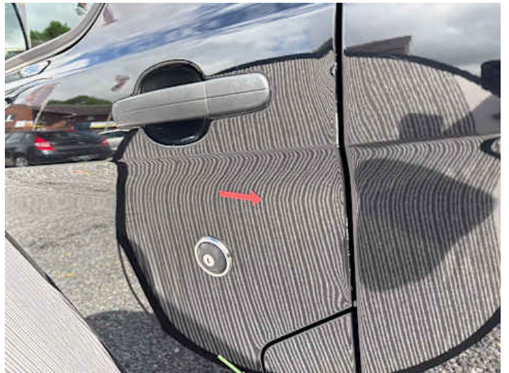
Fahrtür (Kratzer, Lackschaden, Delle)
