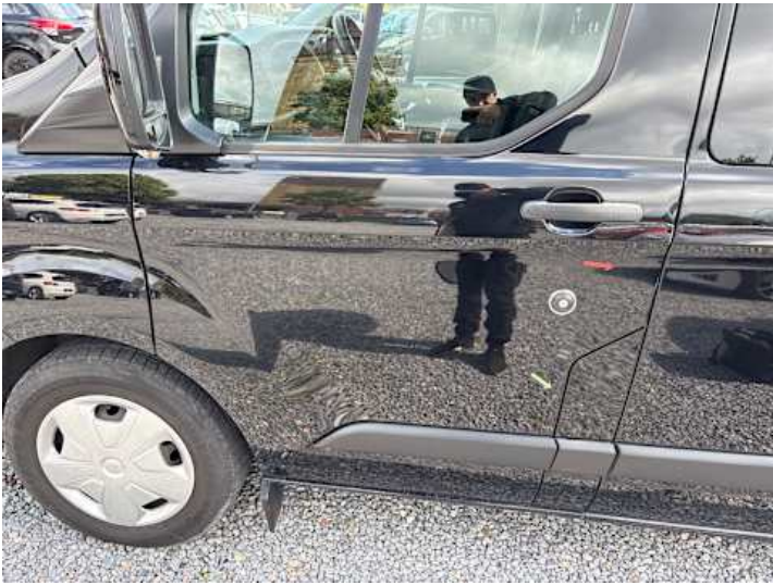
Fahrtür (Kratzer, Lackschaden, Delle)
