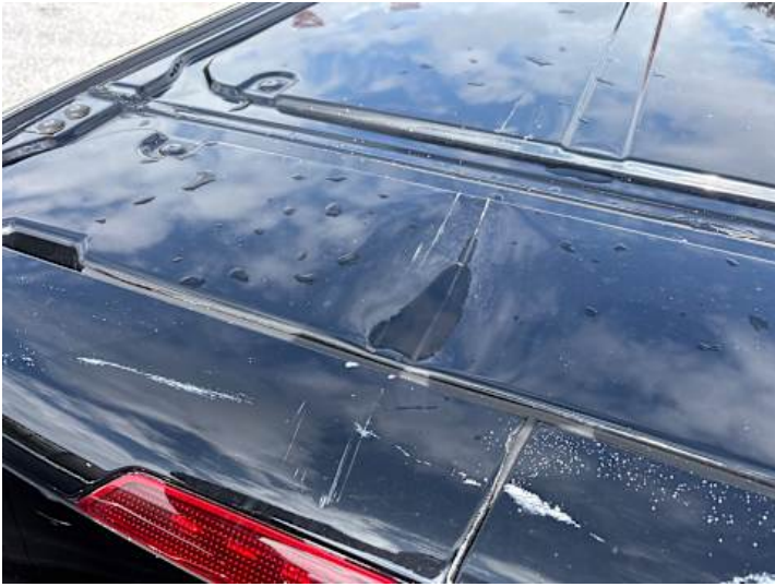
Dach (Kratzer, Delle, Lackschaden)
