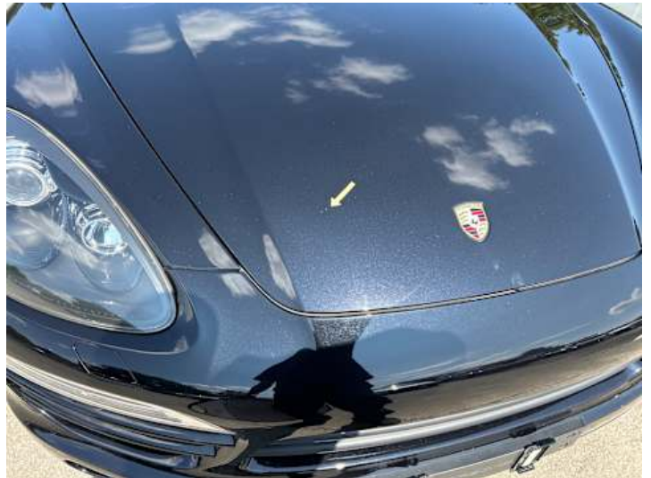
Motorhaube (Lackschaden, Steinschlag)
