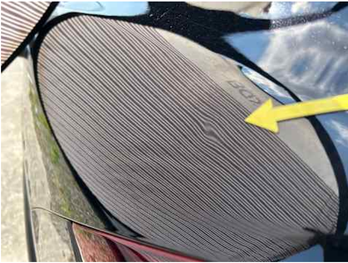
Seitenteil hinten links (Delle)
