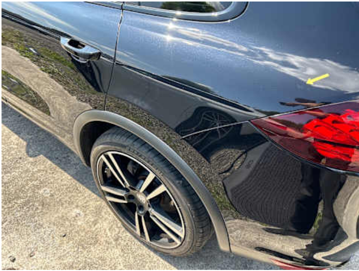
Seitenteil hinten links (Delle)
