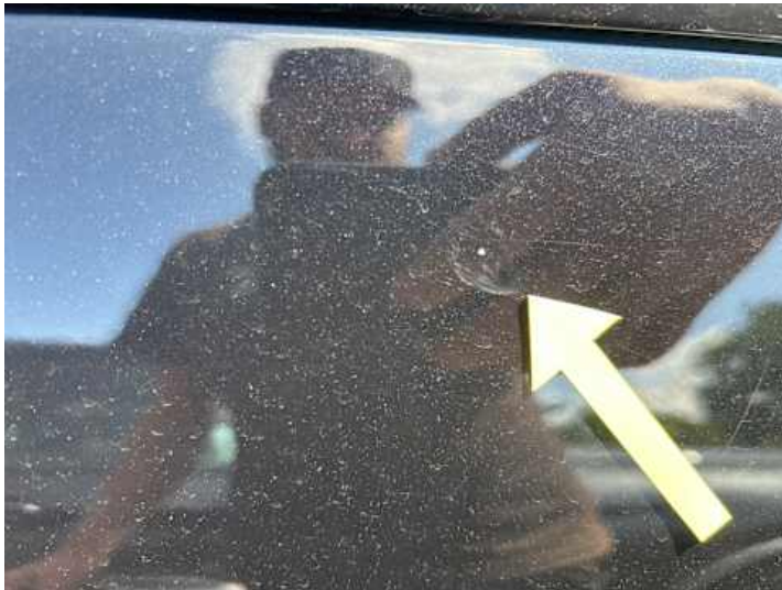
Beifahrtür (Lackschaden, Steinschlag)
