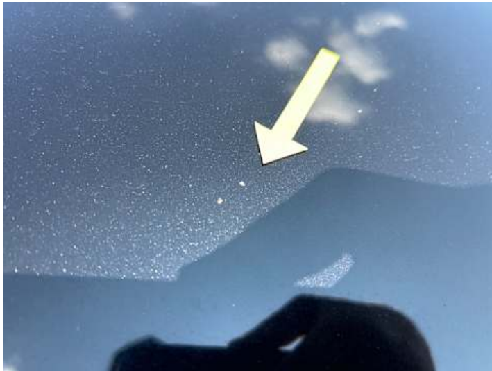
Motorhaube (Lackschaden, Steinschlag)
