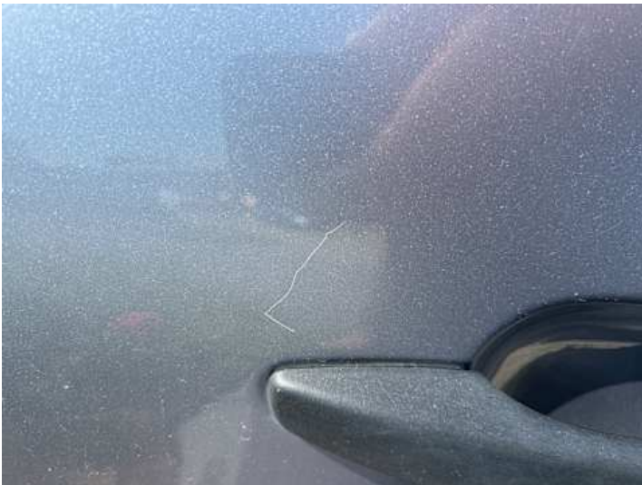
Türe hinten rechts (Kratzer, Lackschaden)
