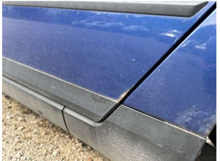
Türe hinten links (Rost)
