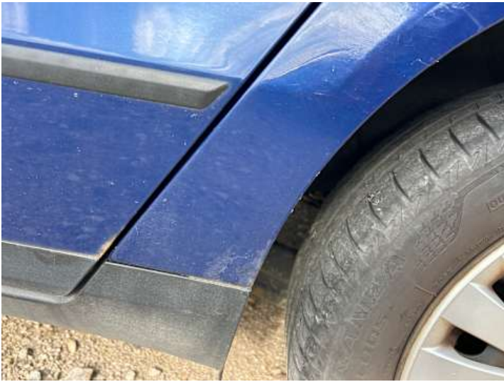
Seitenteil hinten links (Rost)
