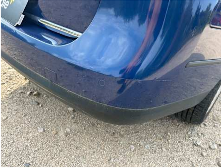
Stoßstange hinten (Kratzer)
