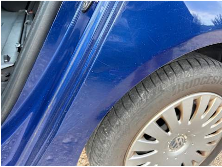
Seitenteil hinten links (Unsachgemäß instand gesetzt, Delle)
