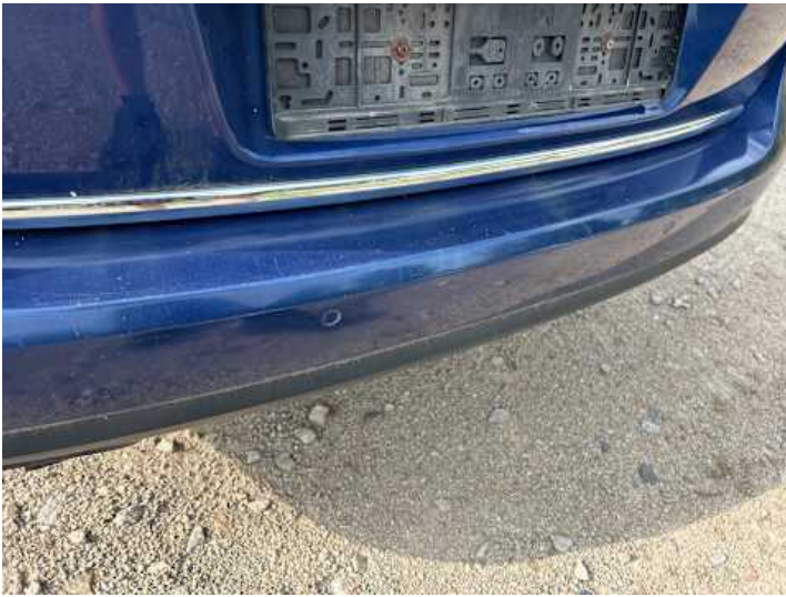
Stoßstange hinten (Kratzer)
