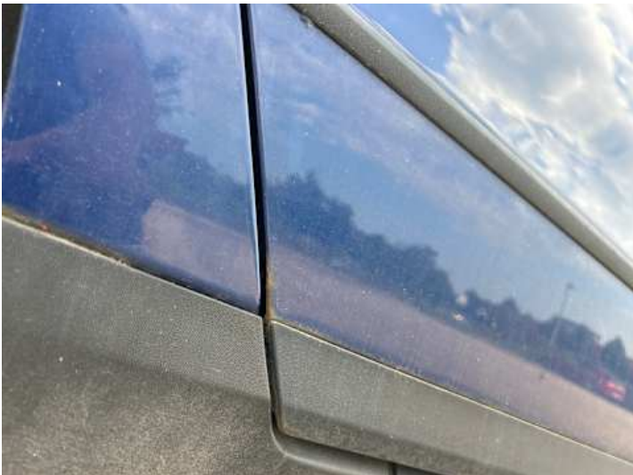
Türe hinten rechts (Rost)
