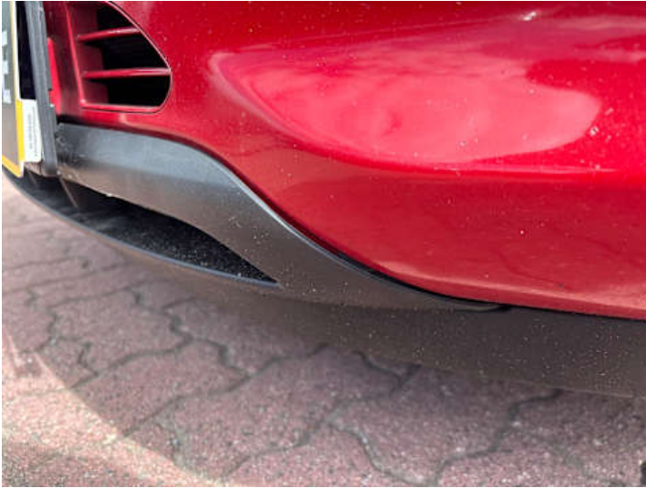
Stoßstange vorne (Spaltmaße ungenau)
