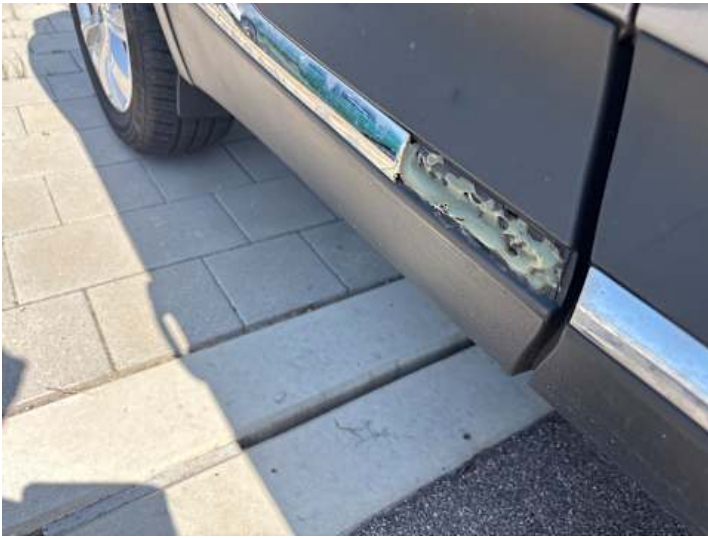
Türe hinten rechts (Riss/Bruch)
