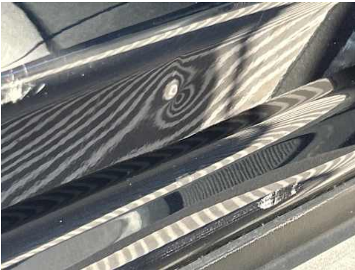
Schweller rechts (Delle)
