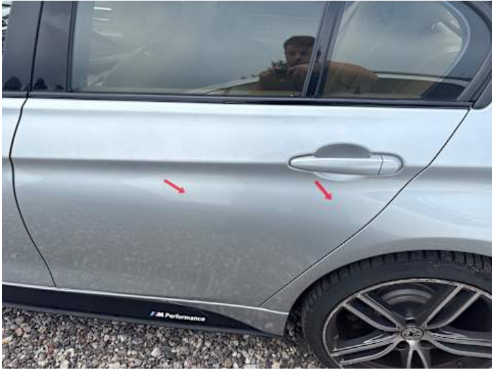
Türe hinten links (Kratzer, Lackschaden)
