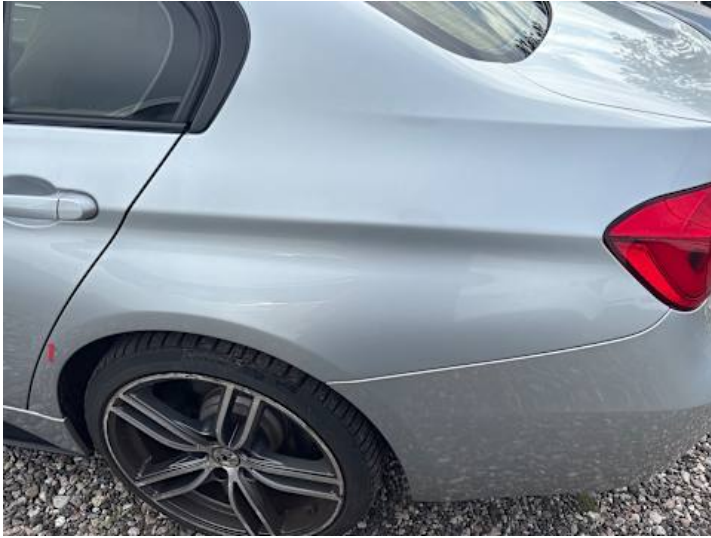
Seitenteil hinten links (Kratzer)
