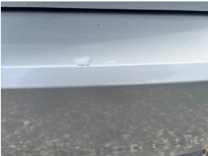
Stoßstange hinten (Lackschaden)
