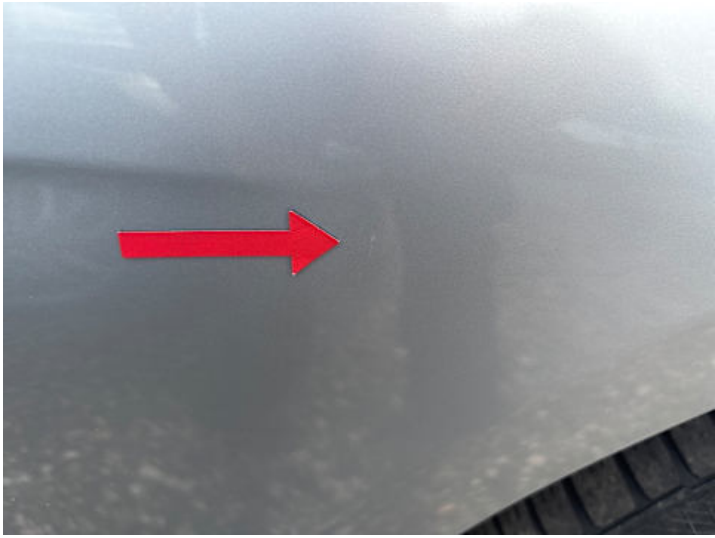
Kotflügel vorne rechts (Kratzer)
