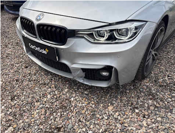
Stoßstange vorne (Riss/Bruch, Lackschaden, Unsachgemäß instand gesetzt)
