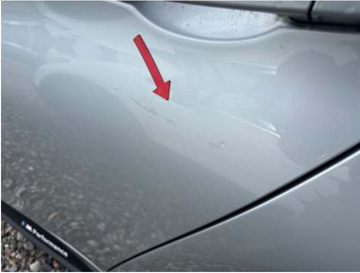
Türe hinten links (Kratzer, Lackschaden)
