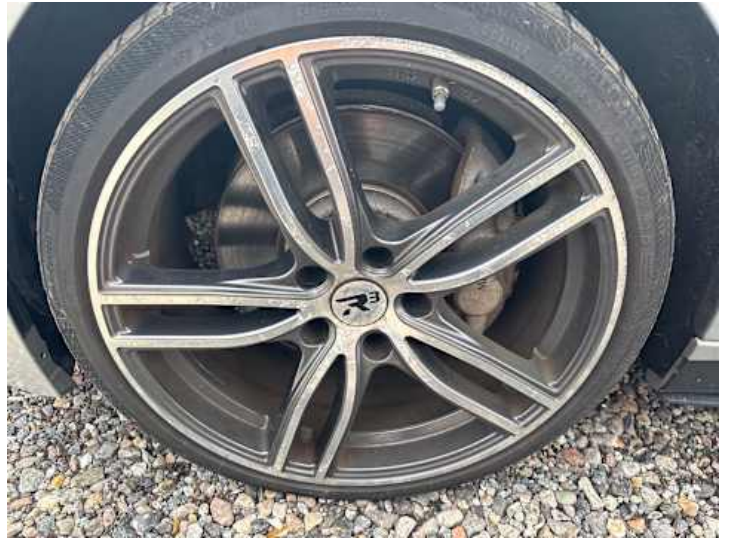
Rad (Ungleichmäßig abgefahren, vehicle.damage-label.porous, Rost)
