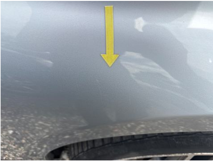
Kotflügel vorne rechts (Kratzer)
