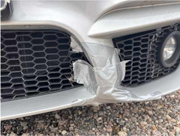
Stoßstange vorne (Riss/Bruch, Lackschaden, Unsachgemäß instand gesetzt)
