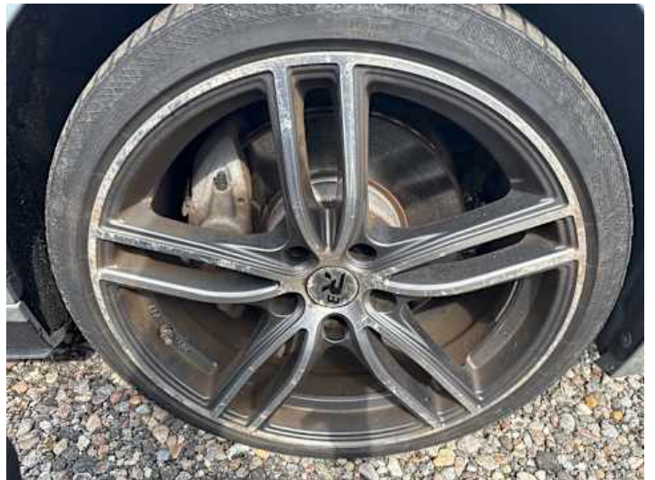
Rad (vehicle.damage-label.porous, Ungleichmäßig abgefahren, Rost)
