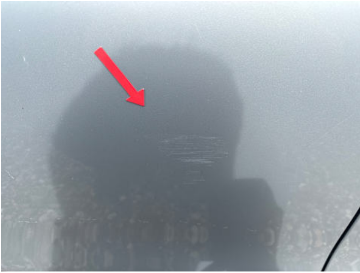
Türe hinten rechts (Kratzer)
