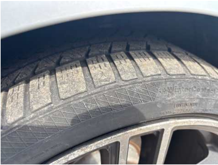
Rad (vehicle.damage-label.porous, Ungleichmäßig abgefahren, Rost)
