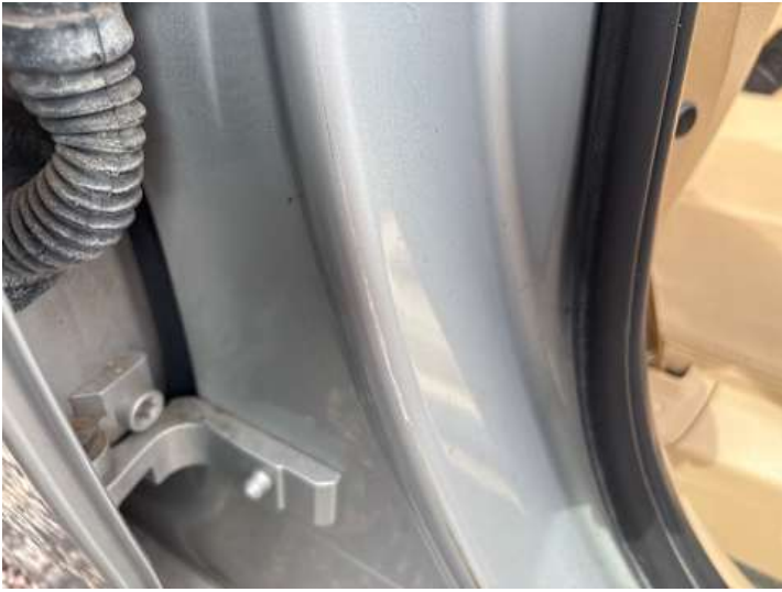
Schweller rechts (Lackschaden)
