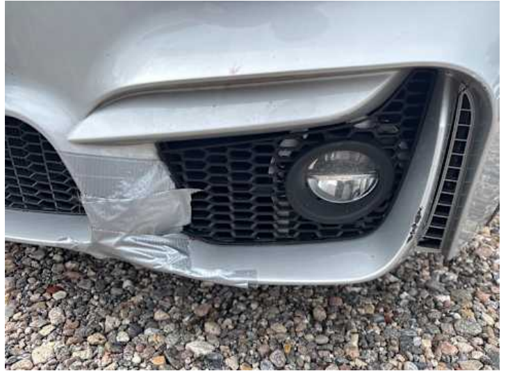
Stoßstange vorne (Riss/Bruch, Lackschaden, Unsachgemäß instand gesetzt)
