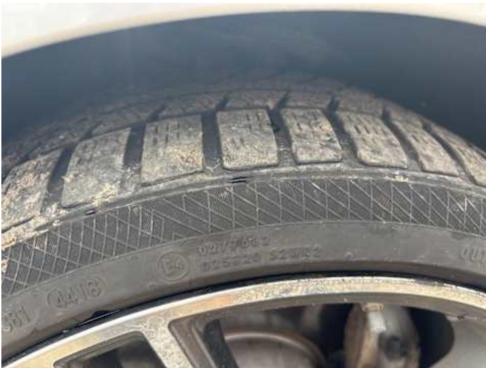
Rad (Ungleichmäßig abgefahren, vehicle.damage-label.porous, Rost)
