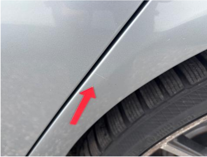
Seitenteil hinten links (Kratzer)
