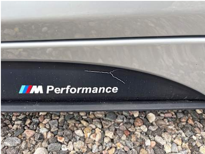
Schweller links (Anderer Schaden): Folie gerissen
