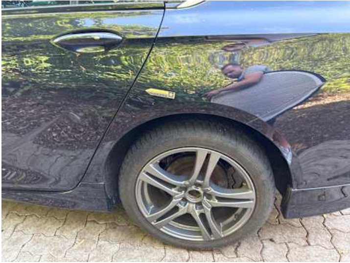
Seitenteil hinten links (Lackschaden, Delle)
