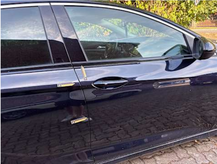
Beifahrertür (Spaltmaße ungenau)
