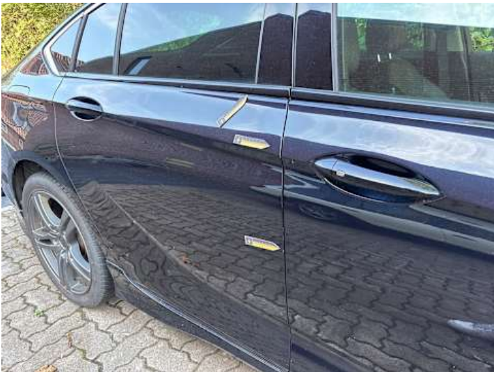
Türe hinten rechts (Lackschaden, Spaltmaße ungenau)
