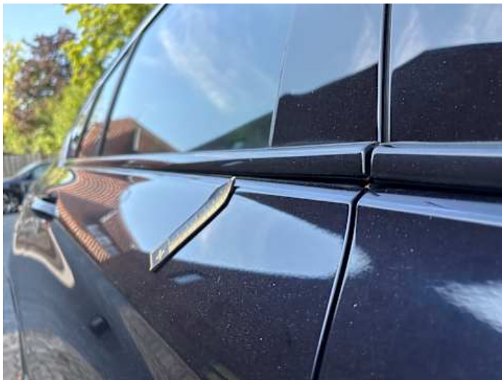
Türe hinten rechts (Spaltmaße ungenau)
