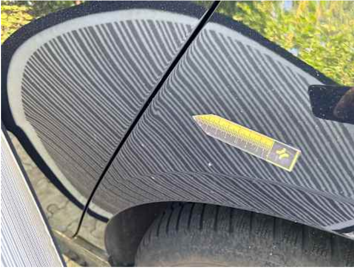
Seitenteil hinten links (Lackschaden, Delle)
