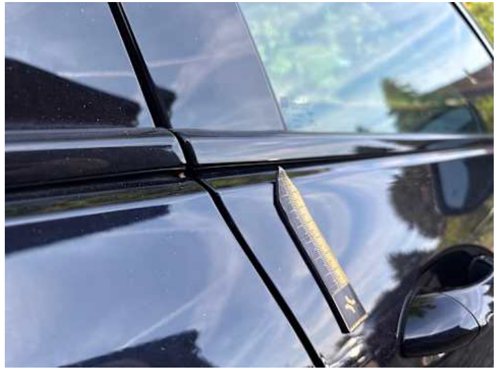
Beifahrertür (Spaltmaße ungenau)
