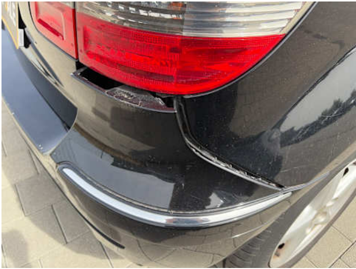
Stoßstange hinten (Spaltmaße ungenau)
