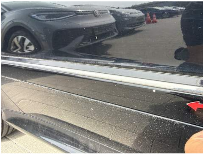
Türe hinten rechts (Lackschaden)
