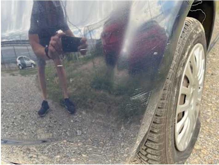
Stoßstange hinten (Kratzer, Riss/Bruch)
