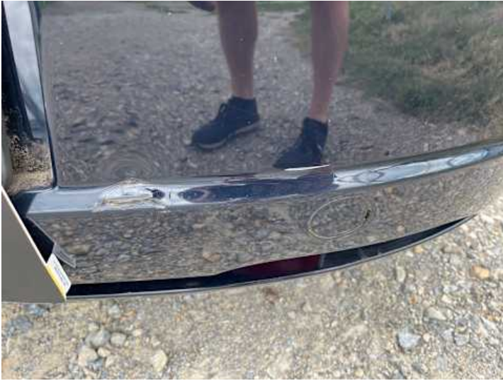
Stoßstange hinten (Kratzer, Riss/Bruch)
