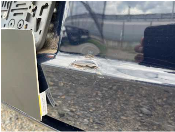
Stoßstange hinten (Kratzer, Riss/Bruch)
