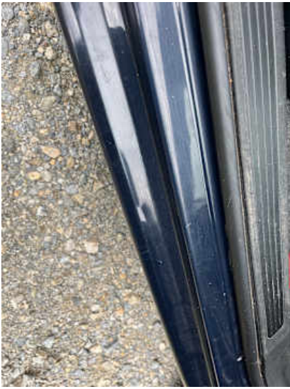
Schweller rechts (Delle, Kratzer)
