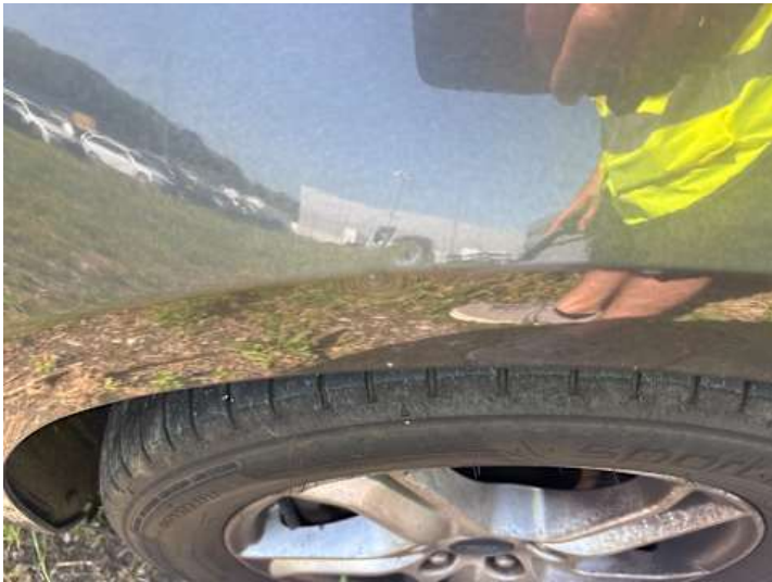
Kotflügel vorne links (Delle, Kratzer)
