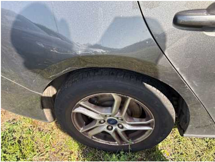
Seitenteil hinten rechts (Kratzer, Verformung)
