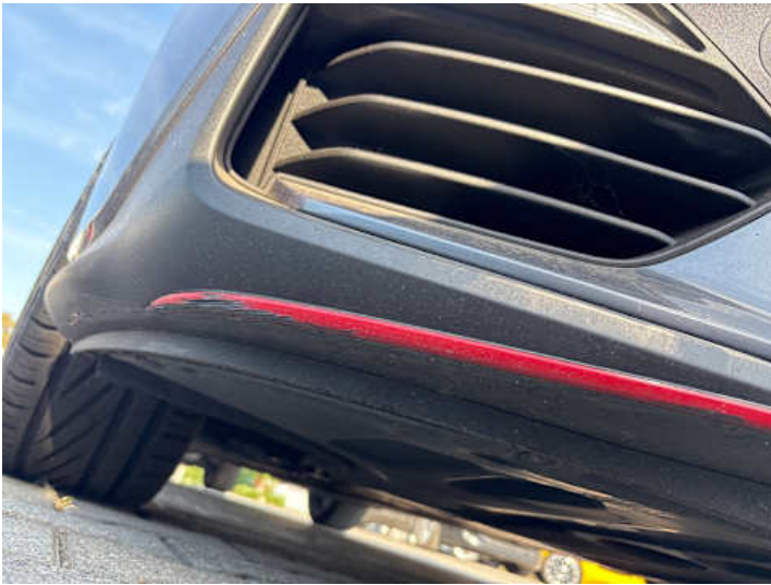
Stoßstange vorne (Kratzer, Lackschaden)
