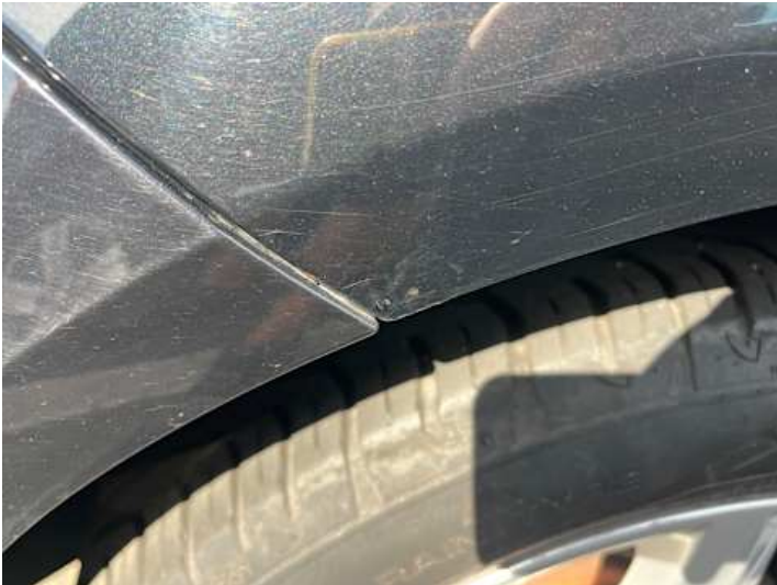
Seitenteil hinten rechts (Rost)
