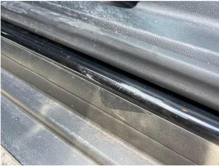
Schweller links (Lackschaden, Kratzer)
