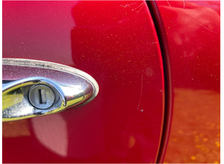
Fahrtür (Lackschaden, Kratzer)
