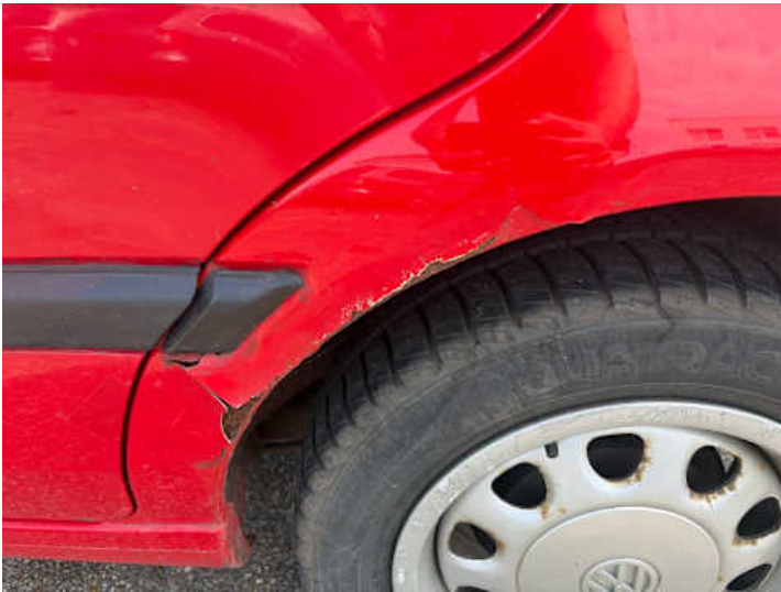
Seitenteil hinten links (Lackschaden, Rost)
