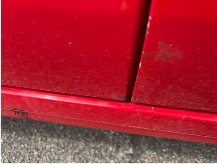
Türe hinten rechts (Rost)
