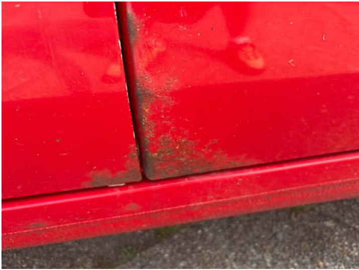
Türe hinten links (Rost)
