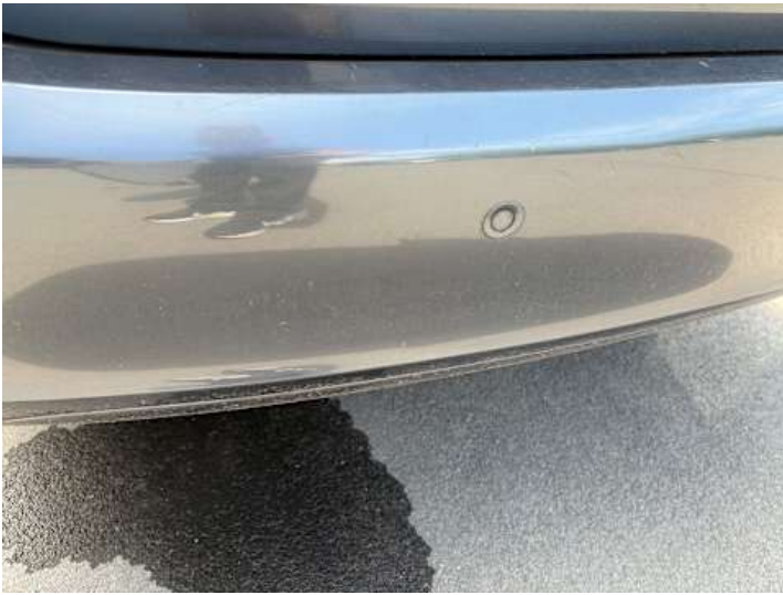
Stoßstange hinten (Lackschaden, Kratzer)
