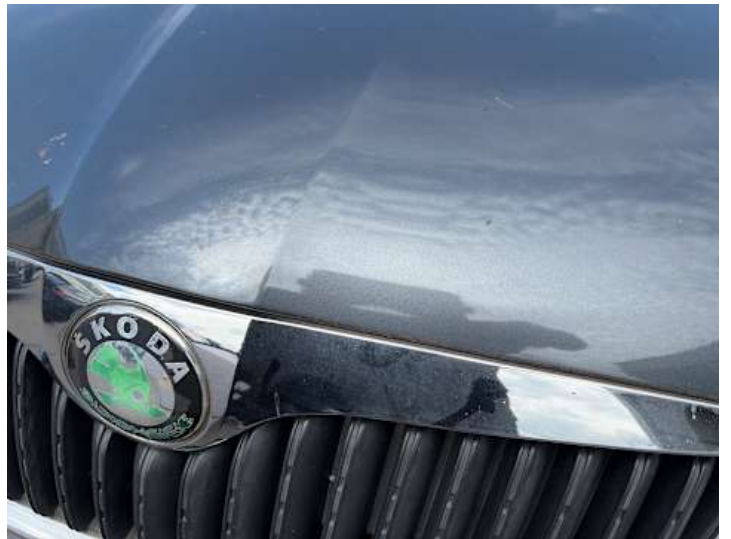
Motorhaube (Lackschaden, Steinschlag)
