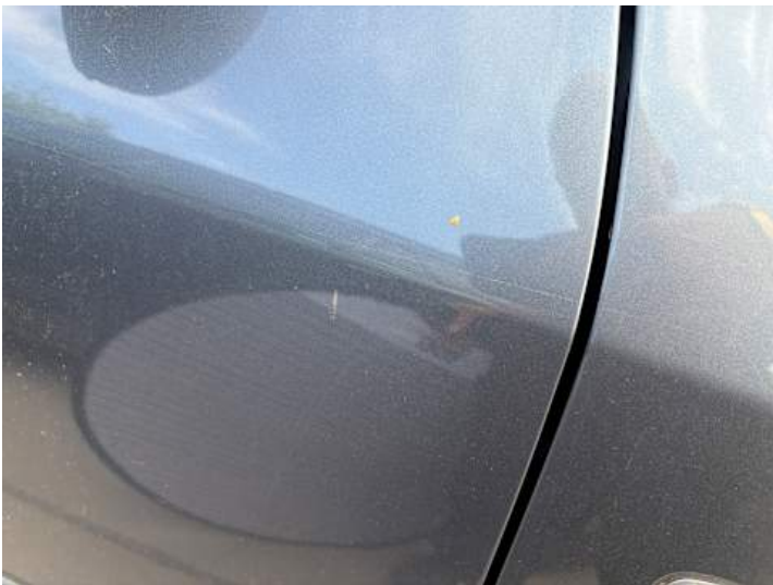
Beifahrertür (Lackschaden, Kratzer)
