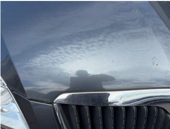
Motorhaube (Lackschaden, Steinschlag)
