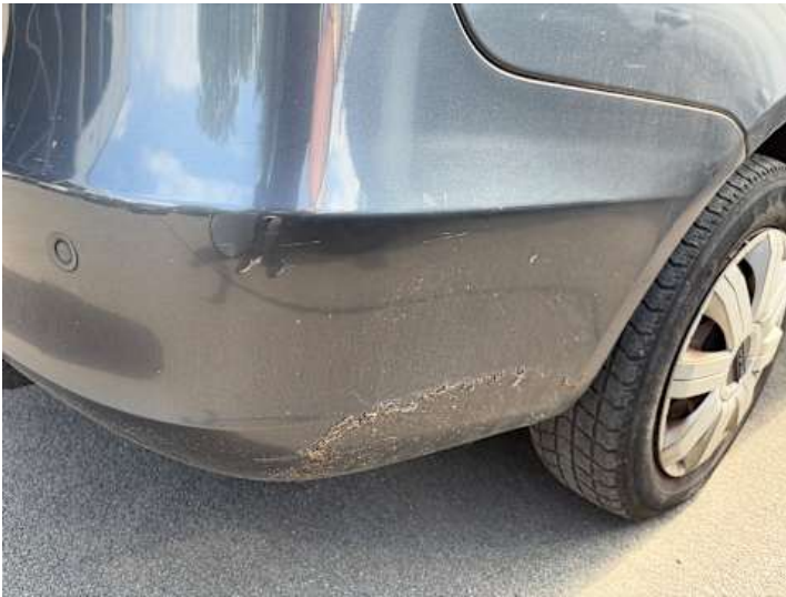
Stoßstange hinten (Lackschaden, Kratzer)
