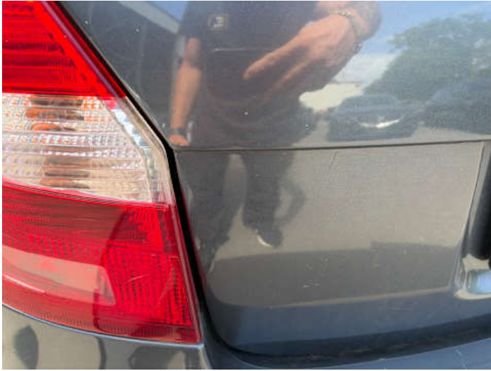
Heckklappe (Lackschaden, Kratzer)
