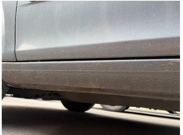
Schweller links (Lackschaden, Verformung, Kratzer)
