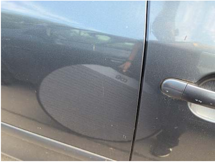
Türe hinten rechts (Lackschaden, Kratzer)
