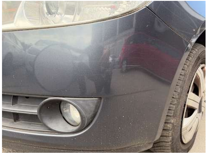
Stoßstange vorne (Kratzer, Lackschaden)
