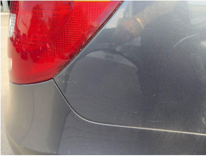
Seitenteil hinten rechts (Lackschaden, Kratzer)
