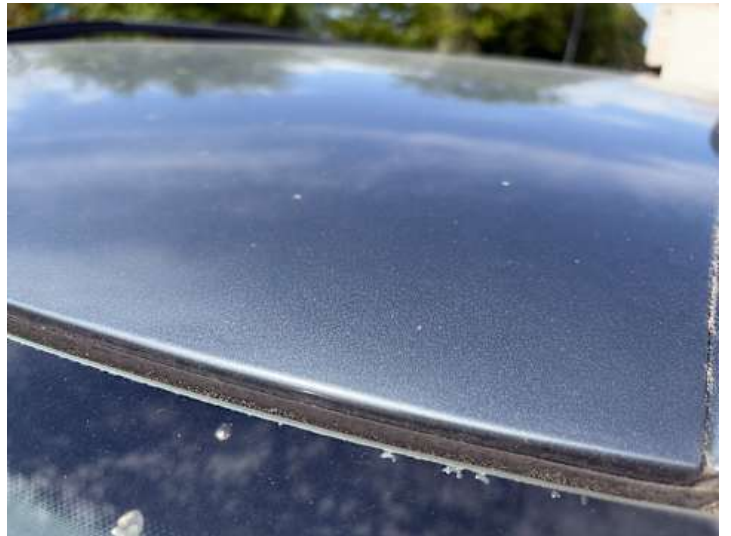
Dach (Lackschaden, Kratzer, Steinschlag)
