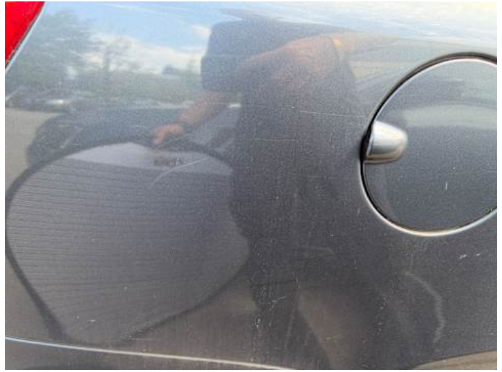
Seitenteil hinten rechts (Lackschaden, Kratzer)
