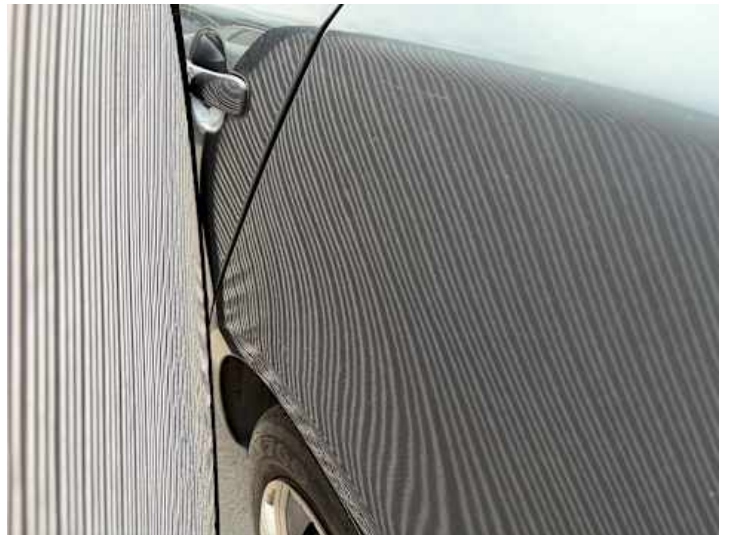
Seitenteil hinten links (Delle)
