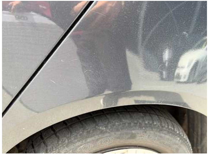
Seitenteil hinten links (Lackschaden, Kratzer)
