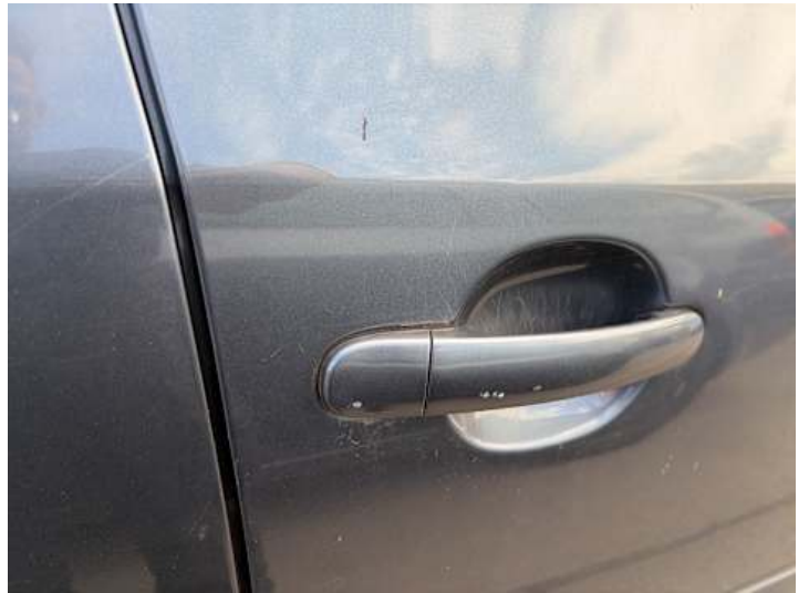
Beifahrertür (Lackschaden, Kratzer)
