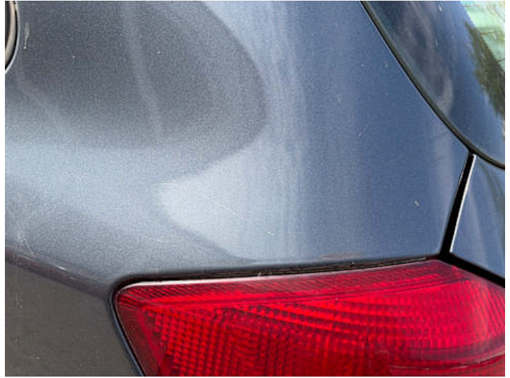
Seitenteil hinten links (Lackschaden, Kratzer)
