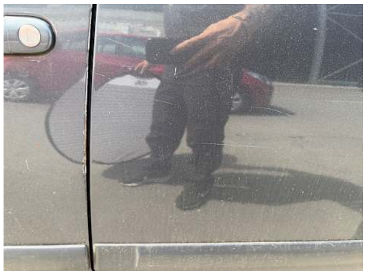
Türe hinten links (Lackschaden, Kratzer)
