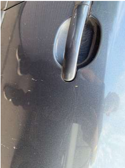
Beifahrertür (Lackschaden, Kratzer)
