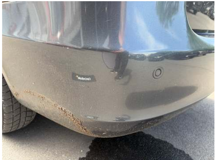
Stoßstange hinten (Lackschaden, Kratzer)
