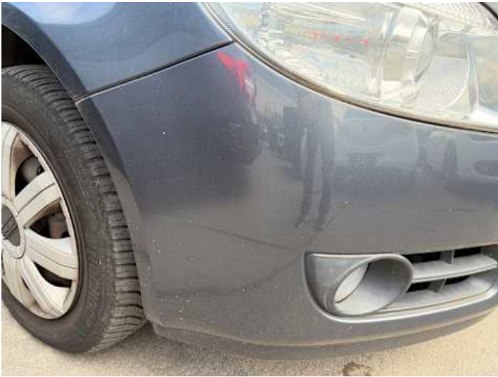
Stoßstange vorne (Kratzer, Lackschaden)
