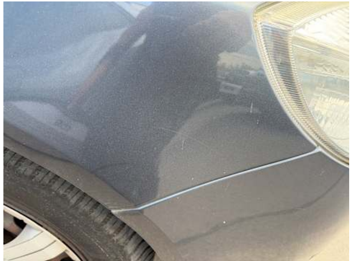
Kotflügel vorne rechts (Lackschaden, Kratzer)
