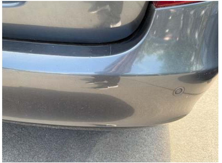
Stoßstange hinten (Lackschaden, Kratzer)
