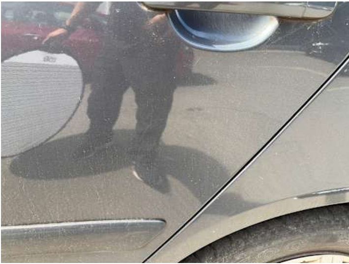
Türe hinten links (Lackschaden, Kratzer)
