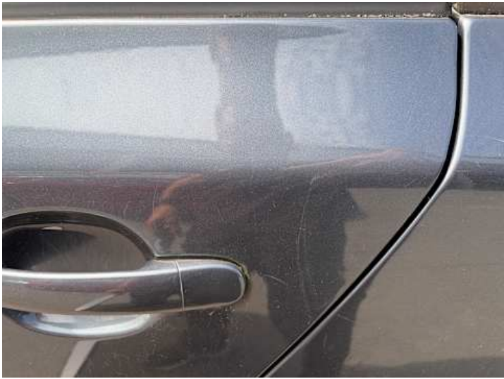
Türe hinten links (Lackschaden, Kratzer)
