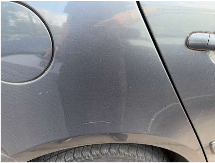
Seitenteil hinten rechts (Lackschaden, Kratzer)
