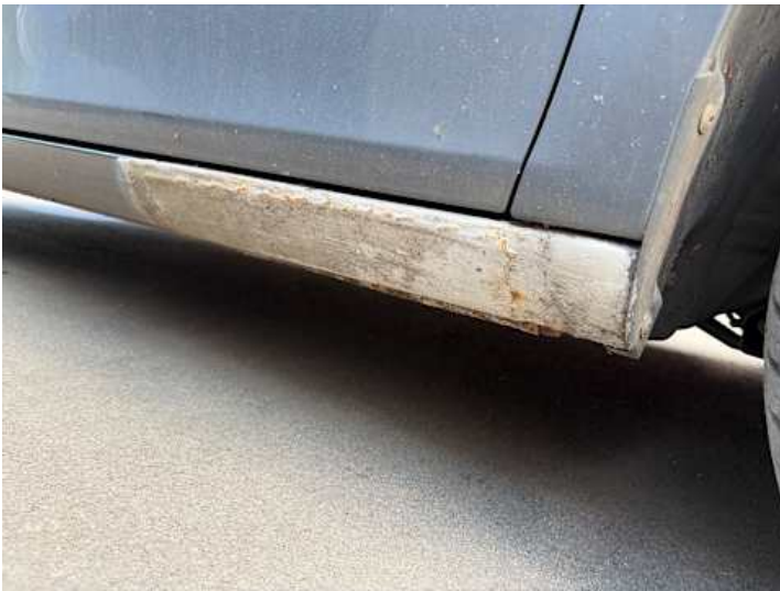
Schweller rechts (Lackschaden, Kratzer, Rost, Unsachgemäß instand gesetzt)
