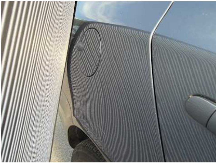
Seitenteil hinten rechts (Delle)
