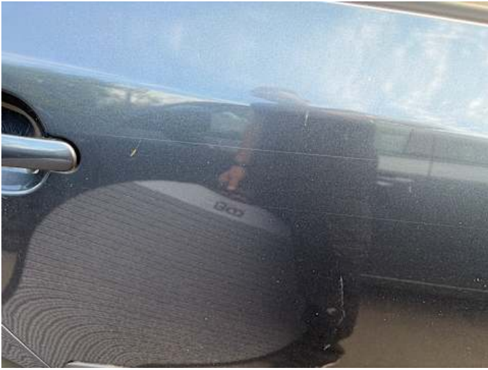
Türe hinten rechts (Lackschaden, Kratzer)
