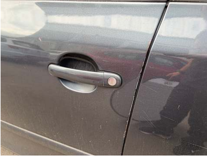
Fahrtür (Lackschaden, Kratzer)
