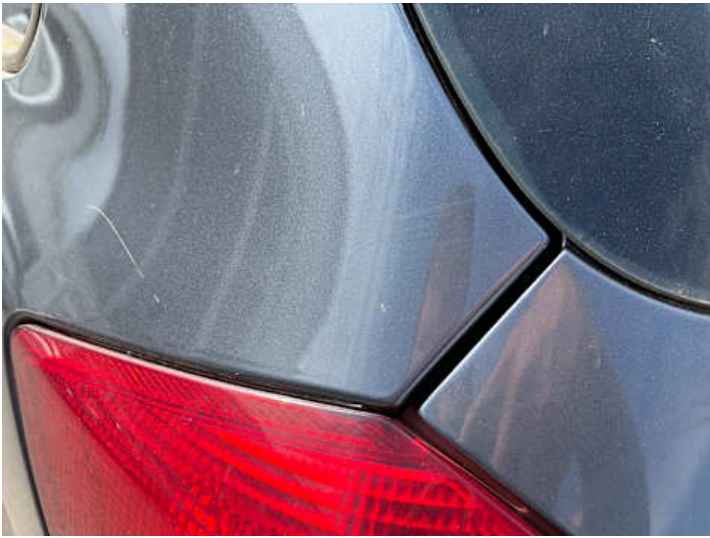
Seitenteil hinten links (Lackschaden, Kratzer)
