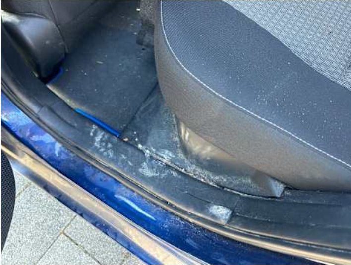
Innenraum (Anderer Schaden): Schimmelbildung
