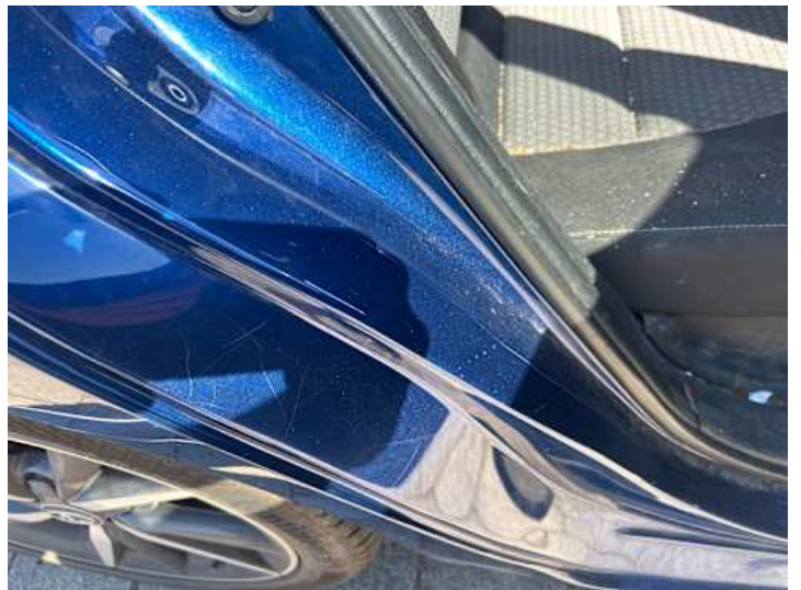
Schweller rechts (Kratzer)
