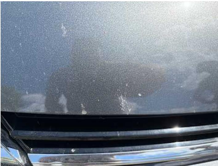
Motorhaube (Steinschlag, Lackschaden)
