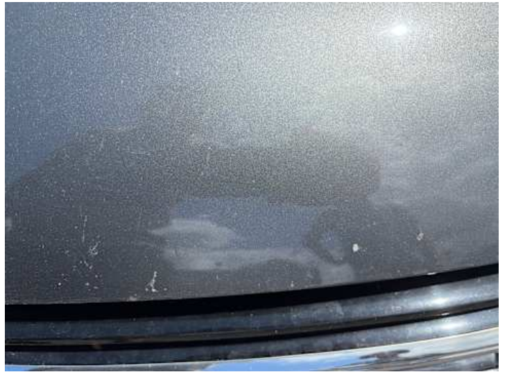
Motorhaube (Steinschlag, Lackschaden)
