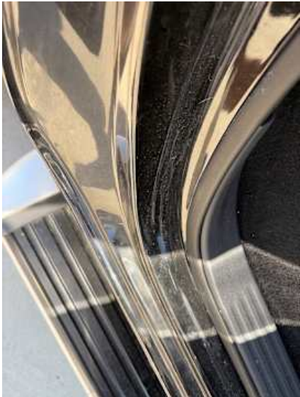
Türe hinten rechts (Kratzer, Lackschaden)
