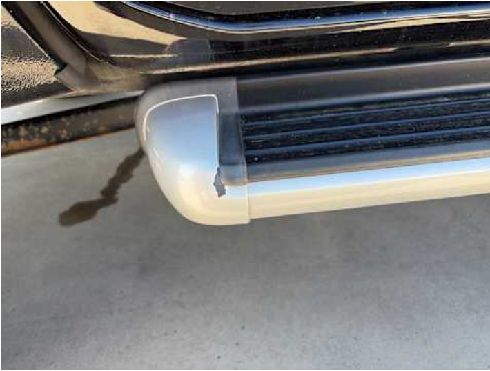
Schweller rechts (Lackschaden)
