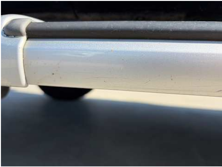
Schweller links (Kratzer)
