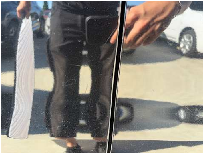
Türe hinten rechts (Kratzer, Lackschaden)
