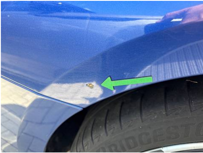
Seitenteil hinten rechts (Rost)
