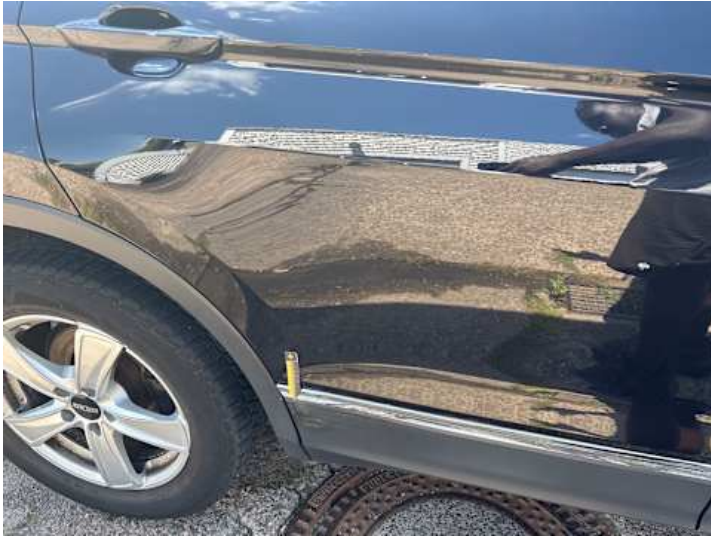
Türe hinten rechts (Kratzer, Verformung)
