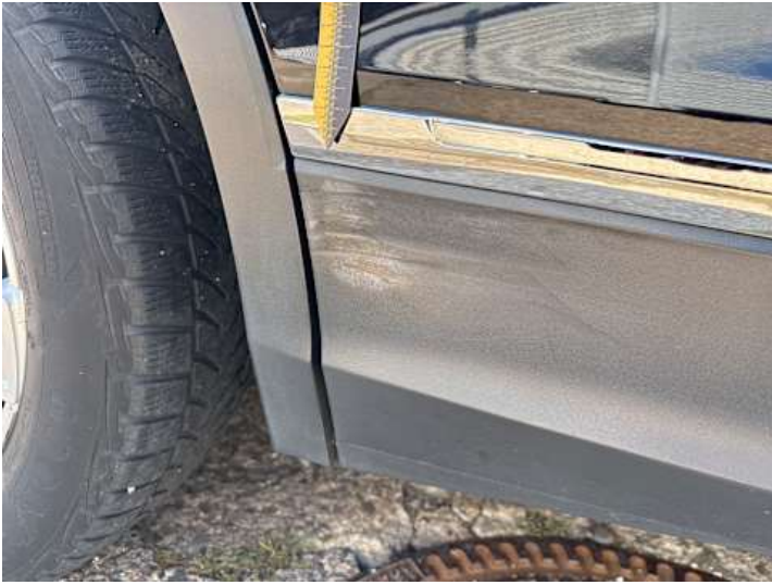
Türe hinten rechts (Kratzer, Verformung)
