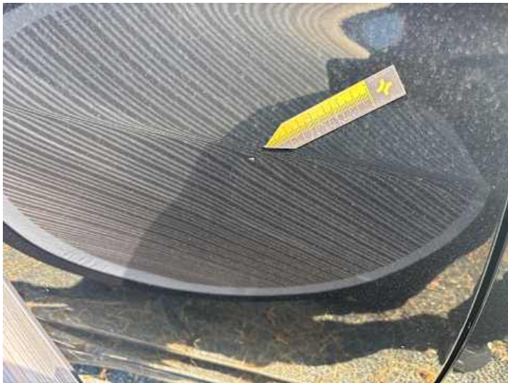
Türe hinten rechts (Kratzer, Delle)
