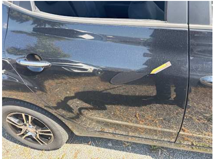
Türe hinten rechts (Kratzer, Delle)
