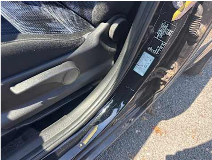
Fahrtür (Kratzer, Delle)
