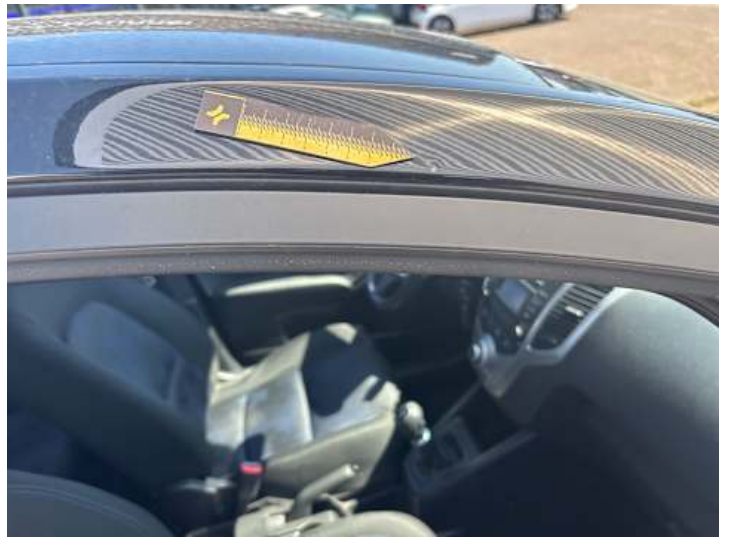
Dach (Kratzer, Delle)
