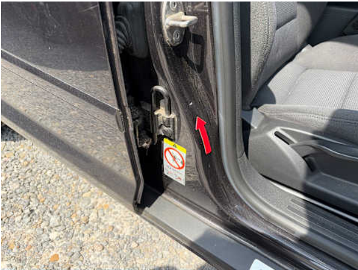
Beifahrertür (Kratzer, Delle)
