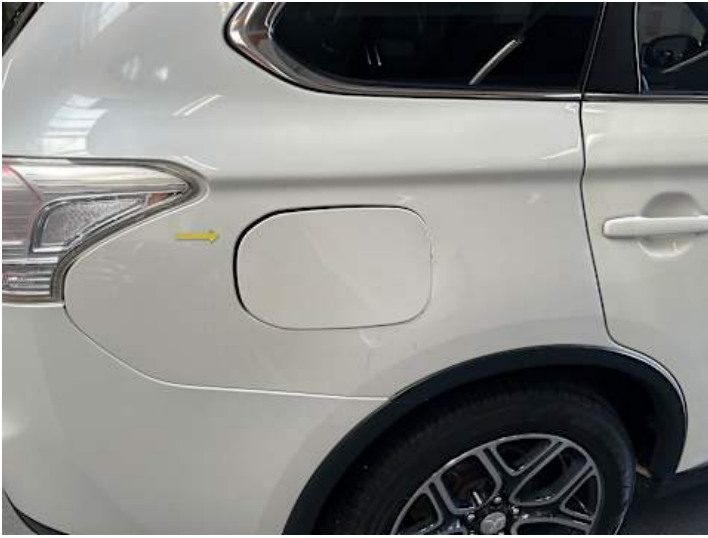
Seitenteil hinten rechts (Spaltmaße ungenau)
