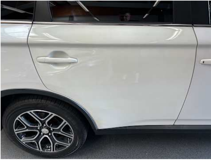
Türe hinten rechts (Unsachgemäß instand gesetzt)
