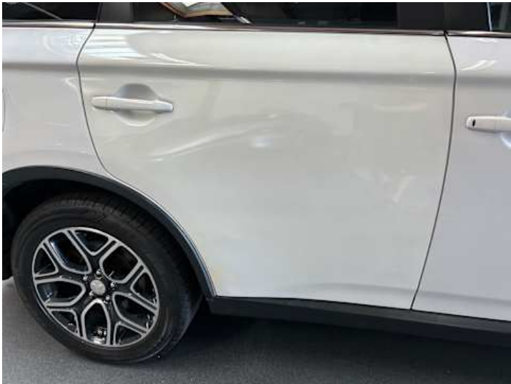
Türe hinten rechts (Unsachgemäß instand gesetzt)
