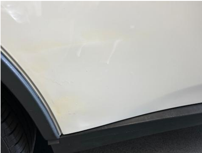
Türe hinten rechts (Unsachgemäß instand gesetzt)
