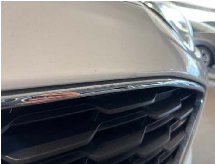
Stoßstange vorne (Verformung, Lackschaden)
