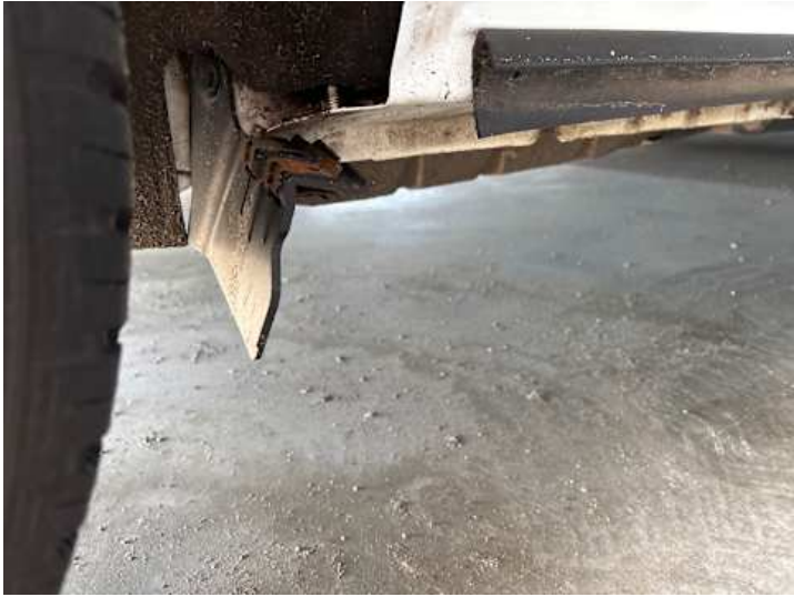
Schweller rechts (Riss/Bruch)
