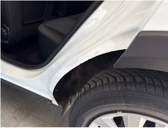
Seitenteil hinten links (Anderer Schaden): Dichtung fehlt
