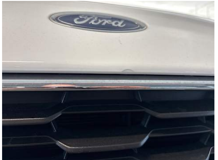
Stoßstange vorne (Verformung, Lackschaden)
