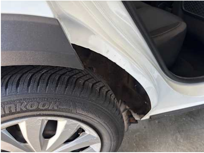
Seitenteil hinten rechts (Anderer Schaden): Dichtung fehlt
