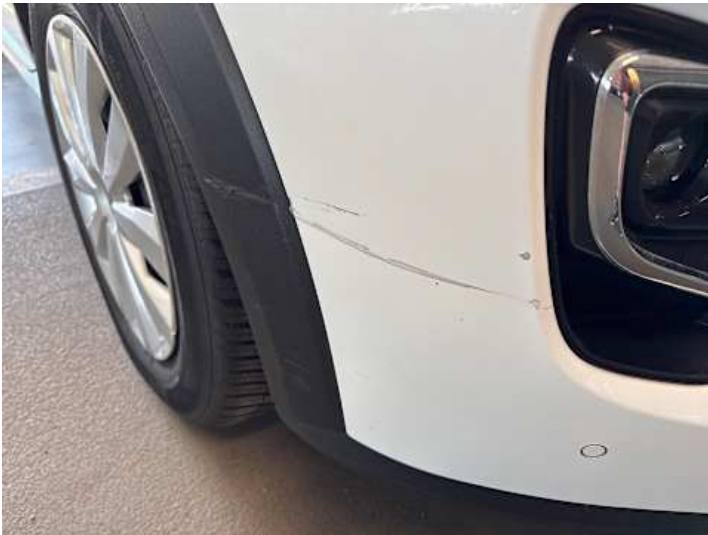
Stoßstange vorne (Verformung, Lackschaden)
