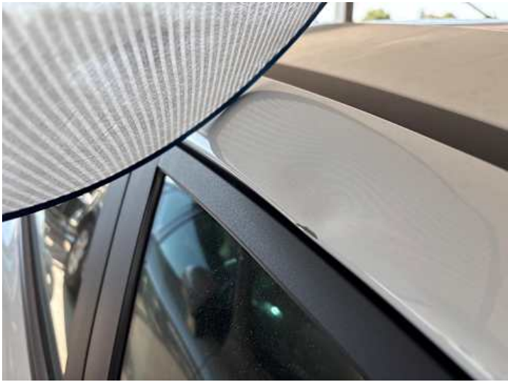
Dach (Lackschaden, Verformung)
