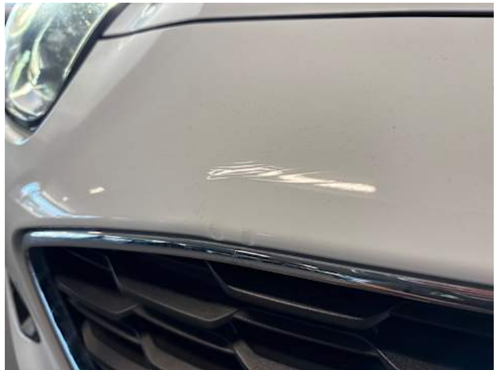
Stoßstange vorne (Verformung, Lackschaden)
