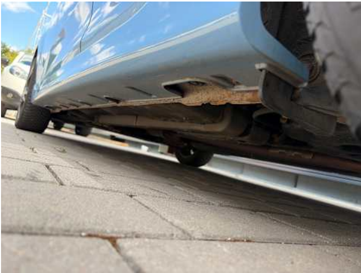
Schweller links (Rost)
