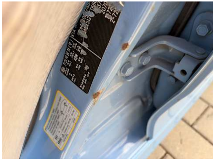
Fahrtür (Kratzer, Delle, Rost)
