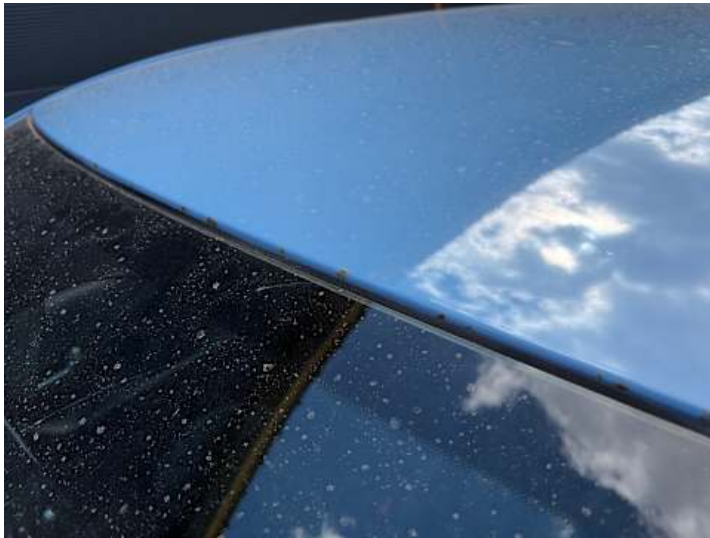
Dach (Steinschlag, Rost)
