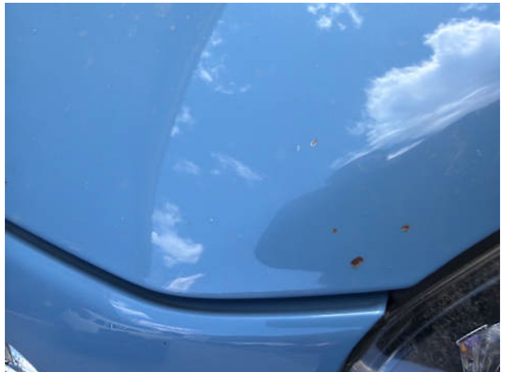
Motorhaube (Rost, Delle)
