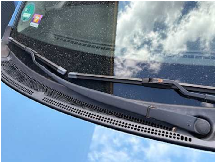
Windschutzscheibe (Anderer Schaden): Wischer Korrosion;
