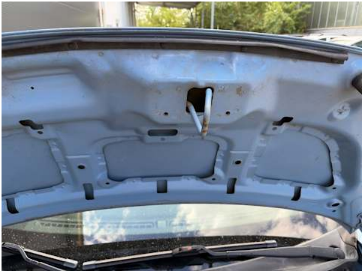
Motorhaube (Rost, Delle)
