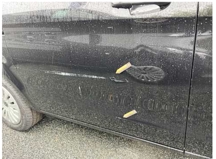
Türe hinten rechts (Verformung, Kratzer)
