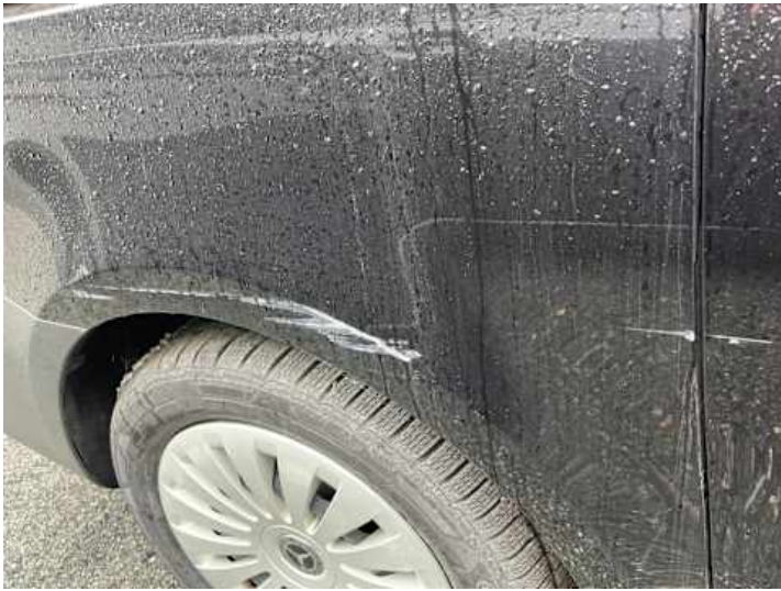
Seitenteil hinten rechts (Kratzer, Verformung)
