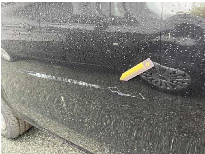
Türe hinten rechts (Verformung, Kratzer)
