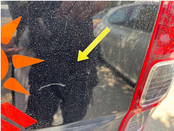
Heckklappe (Kratzer, Lackschaden)
