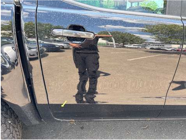
Türe hinten rechts (Kratzer, Lackschaden)
